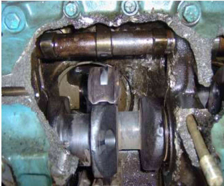
Фотографија 7 – Изглед оштећења на месту цилиндара број 4
