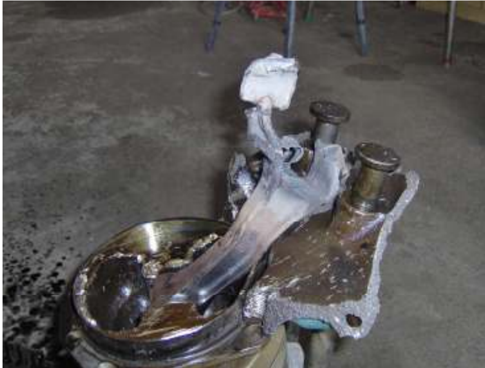
Фотографија 9 – Деталъ оштећења подскопа клипњача-клип цилиндра број 4
