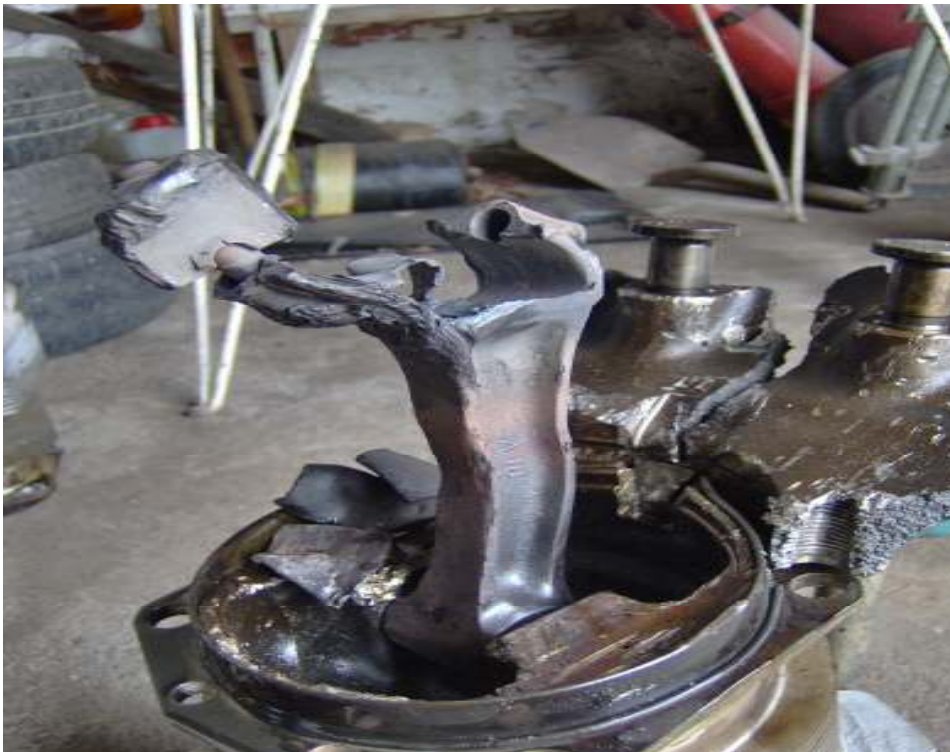
Фотографија 10 – Деталъ оштећења подскопа клипњача-клип цилиндра број 4
