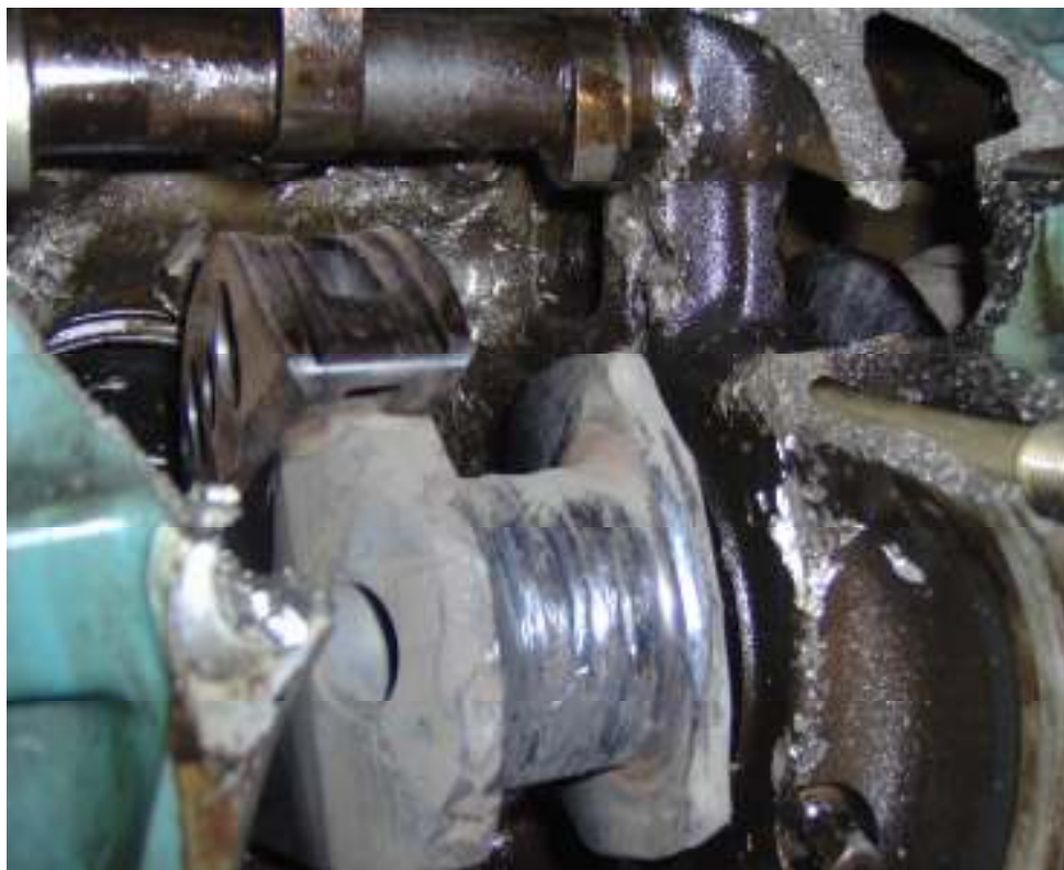
Фотографија 8 –Детаљ оштећења летећег рукавца коленастог вратила цилиндара број 4
