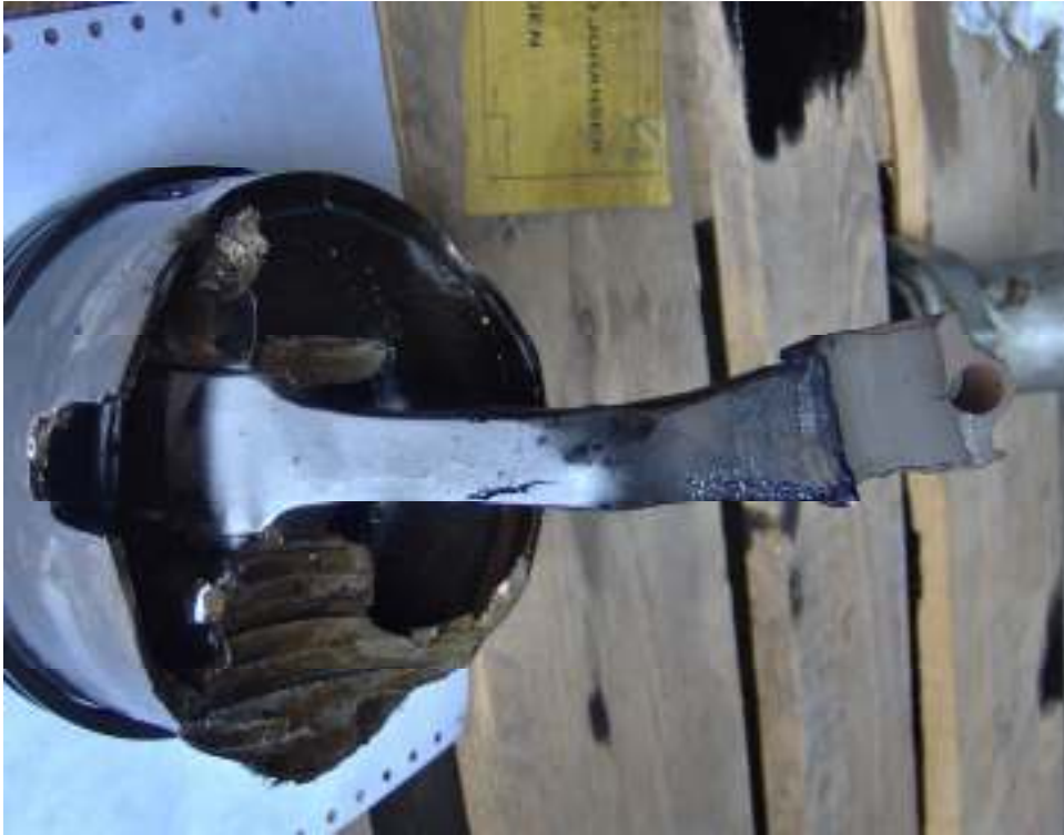
Фотографија 11 – Деталъ оштећења подскопа клипњача-клип цилиндра број 3
