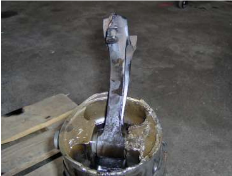
Фотографија 11 – Деталъ оштећења подскопа клипњача-клип цилиндра број 5
