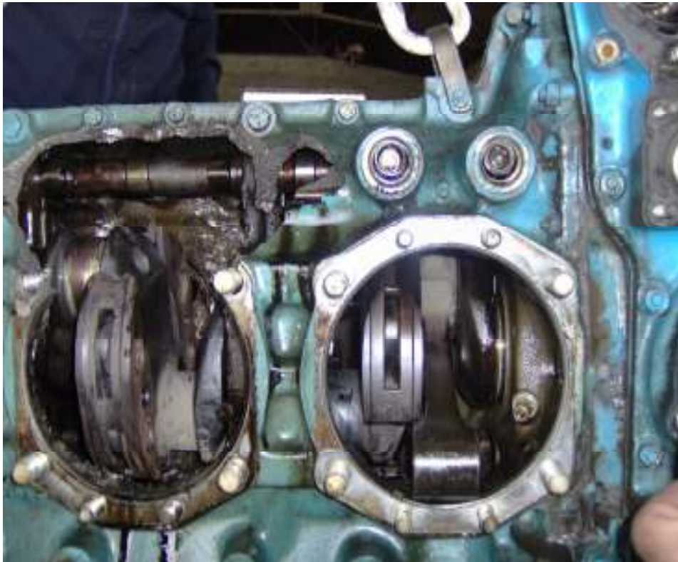
Фотографија 6 – Диспозиција оштећења на месту скинутих цилиндара број 4 и 6
