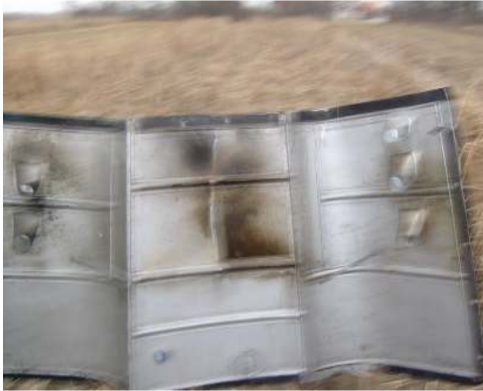
Фотографија 5 – Скинути горњи поклопац ( капотаж ) мотора, са незнатним траговима уља
