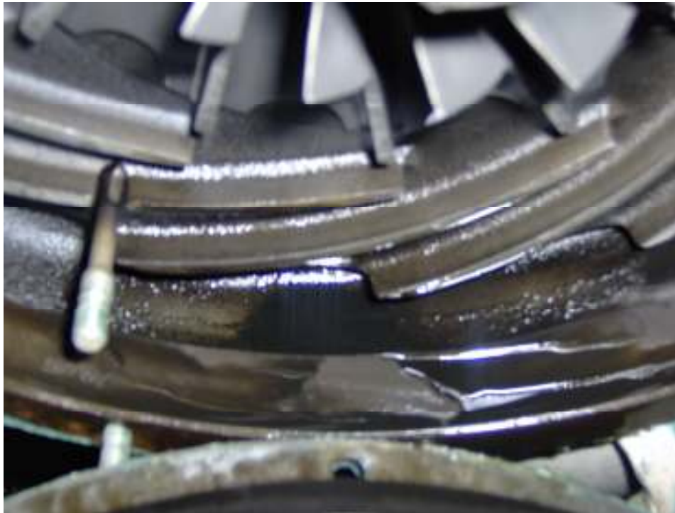
Фотографија 2- Детал статорског дела компресора са траговима уља и опиљака
