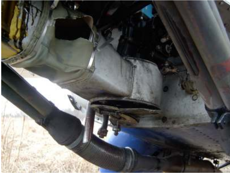
Фотографија 3 – Оштећење коже уводника ваздуха и поклопца карбуратора са видљивим траговима уља из оштећеног цилиндра број 4
