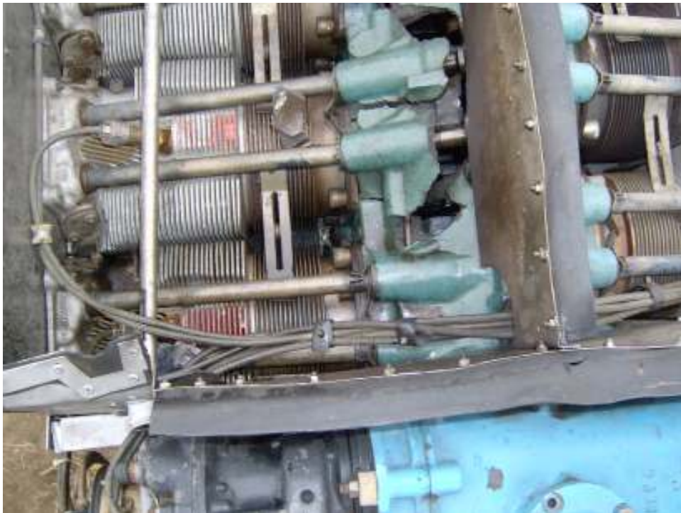
Фотографија 4 - Оштећење кућишта мотора на позицији цилиндра број 4
