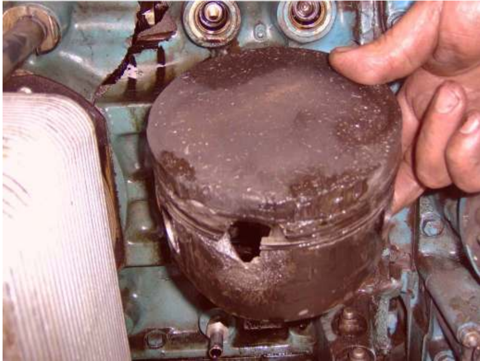
Фотографија 5 – Оштећени клип цилиндра број 6
