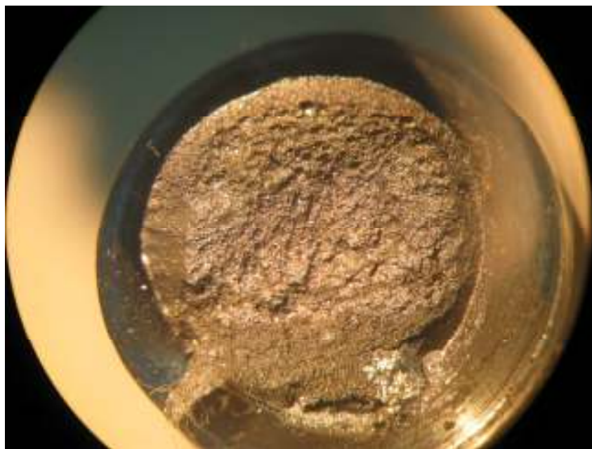
Б) Преломна површина дела навојног вретена који је остао у цеви
