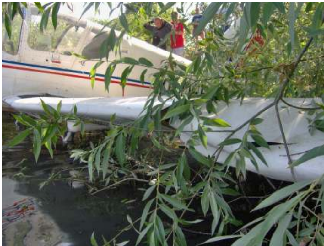
Сл. 7. Оштећења левог крила услед удара уврха крила о водену површину
