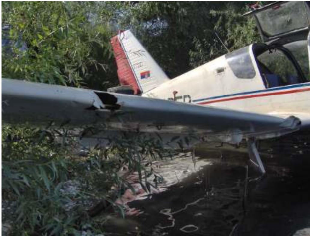
Сл. 6. Трагови удара у подводну конструкцију сплава и јарбол једрилице на десном крилу
