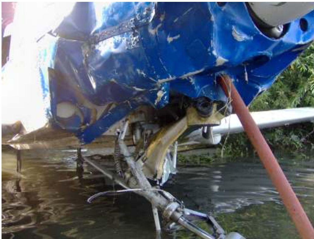
Сл. 5. Оштећења капотажа мотора и носне ноге
