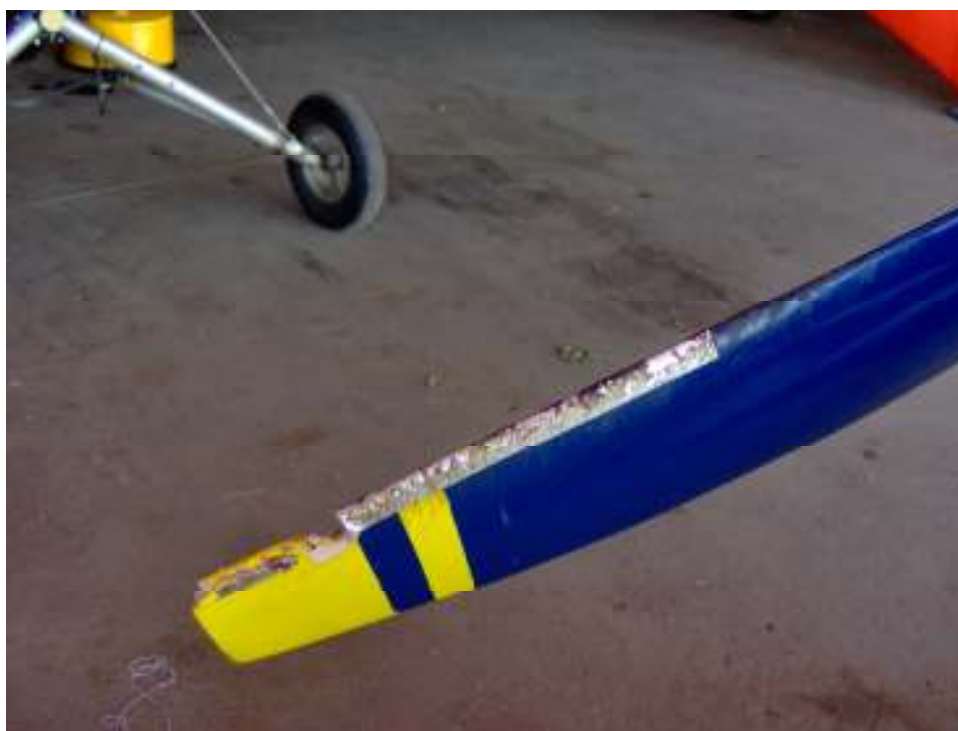
Слика 2. Оштећења елисе змаја
