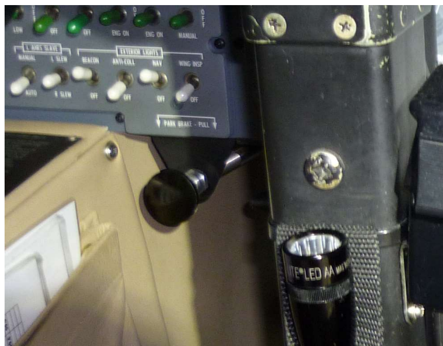
Слика 29. Положај ручице за паркинг кочицу која се налази испред левог пилота испод инструмент табле (сликано током увиђаја)
