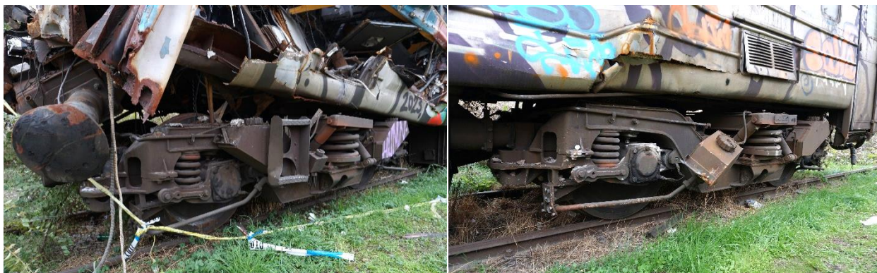
Слика 4.2.5.2: Изглед оштећења обртних постоља моторних кола 412-005
