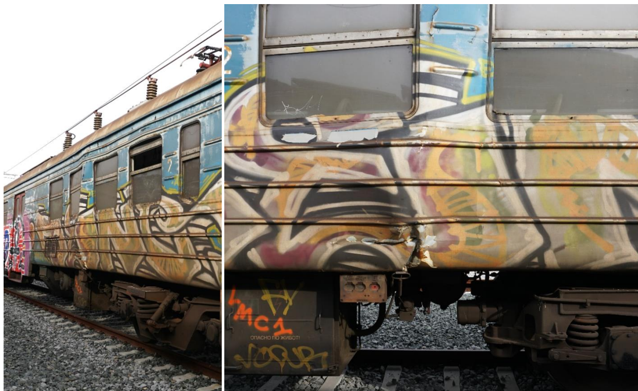
Слика 4.2.5.13: Изглед оштећења на сандуку приколице 416-013
