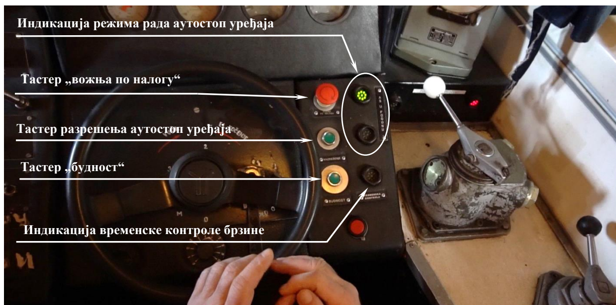
Слика 4.2.5.19: Изглед блока прекидача и сигналних сијалица аутостоп уређаја
