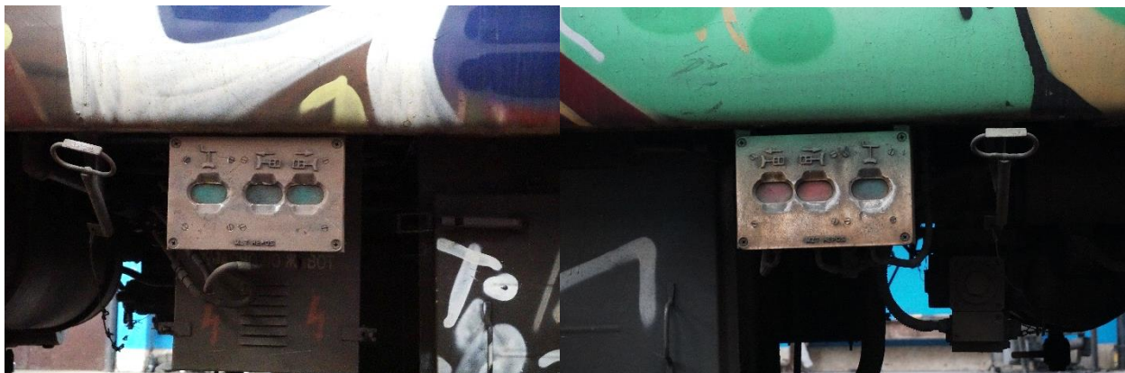
Слика 4.2.5.17: Изглед индикатора заочености на приколици 416-013 (у положају откочено) и приколици 416-095 (у положају заочно)
