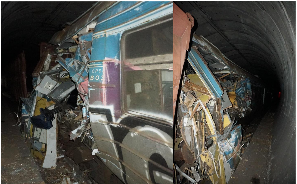
Слика 4.1.2: Изглед оштећења на предњем делу моторних кола 412-005 код воза број 7112 после несреће
