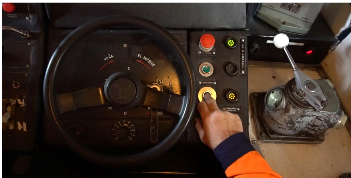
Слика 4.2.5.20: Изглед употребе тастера „будност“ и индикације временске контроле брзине
