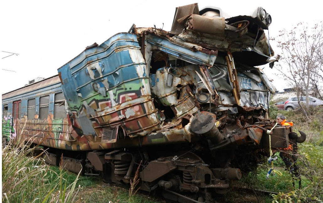
Слика 4.2.5.3: Изглед оштећења предњег дела моторних кола 412-005
