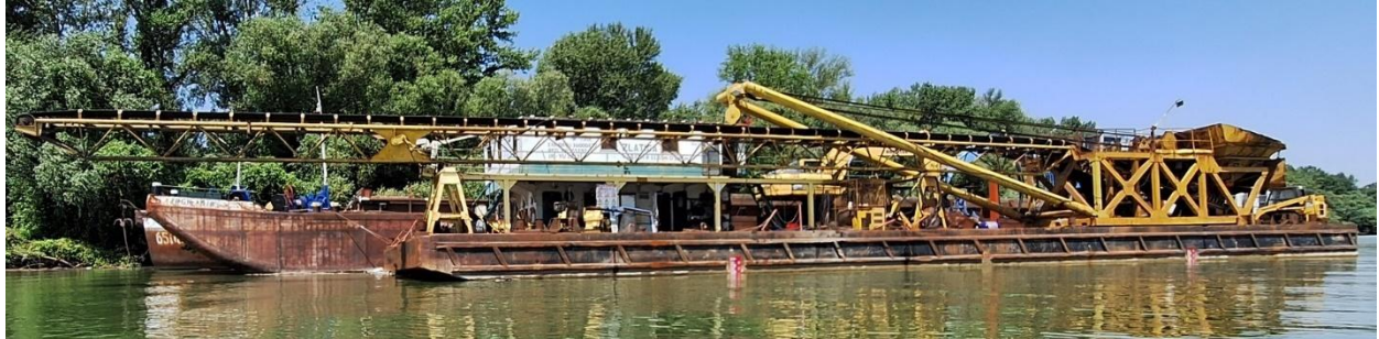
Слика 3.1.2.1. Технички пловни објекат – елеватор „ZLATICA“
