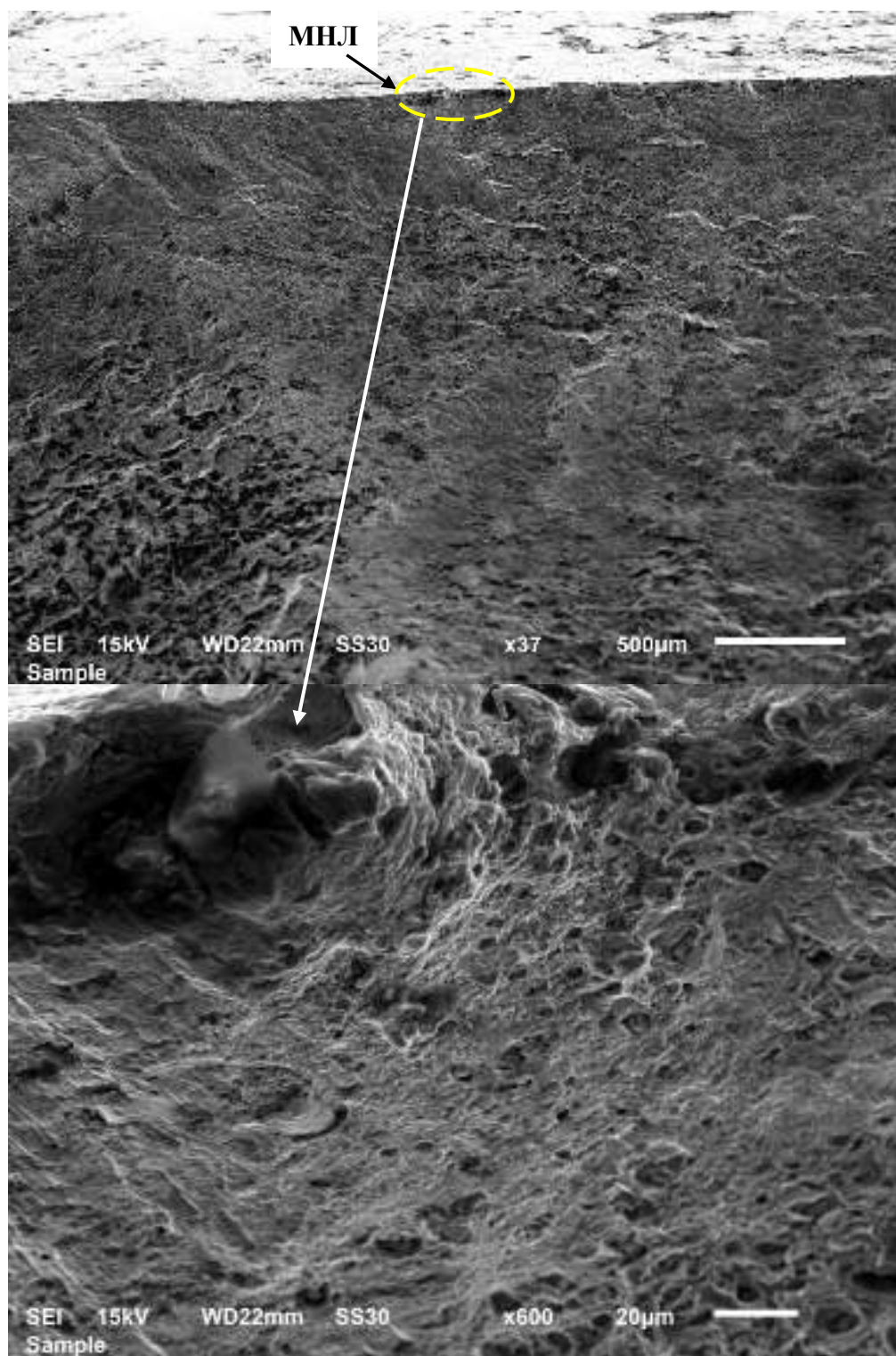
Слика 37. Изглед преломне површине 1 на маказама 1 код МНЛ
