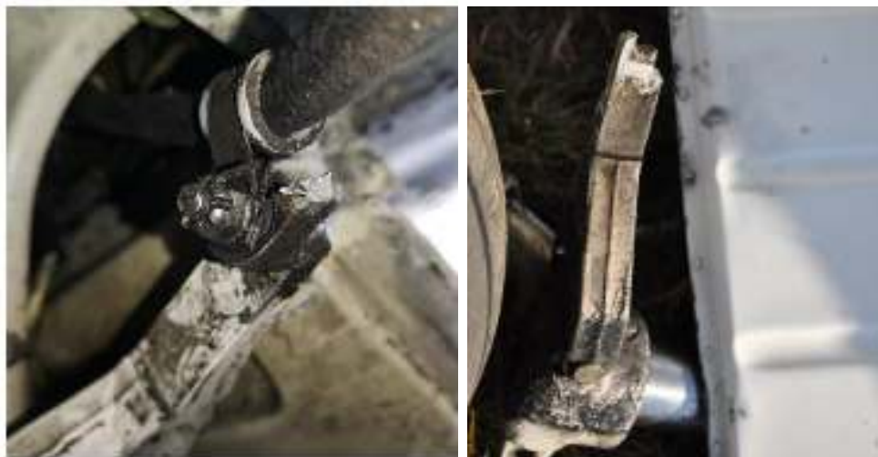
Слика 4. Прелом маказа на нози стајног трапа
