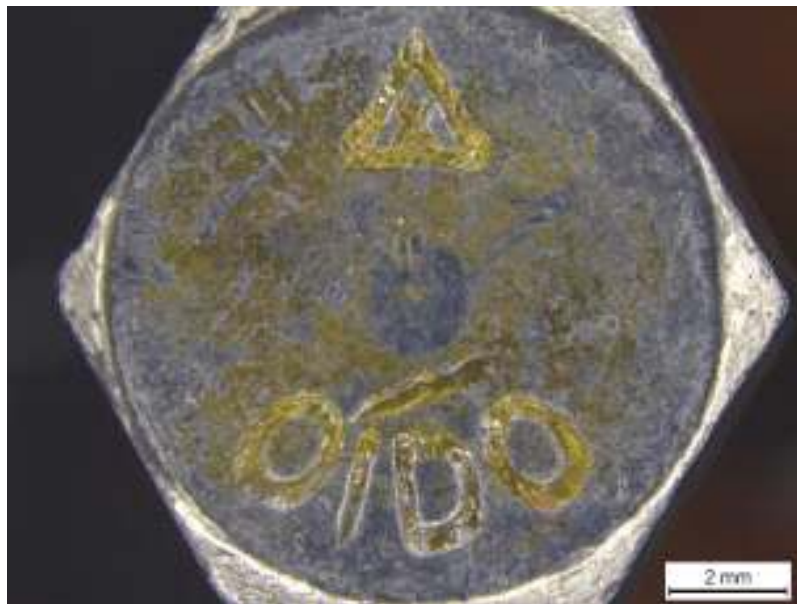
Слика 18. Изглед ознаке на глави вијка.
