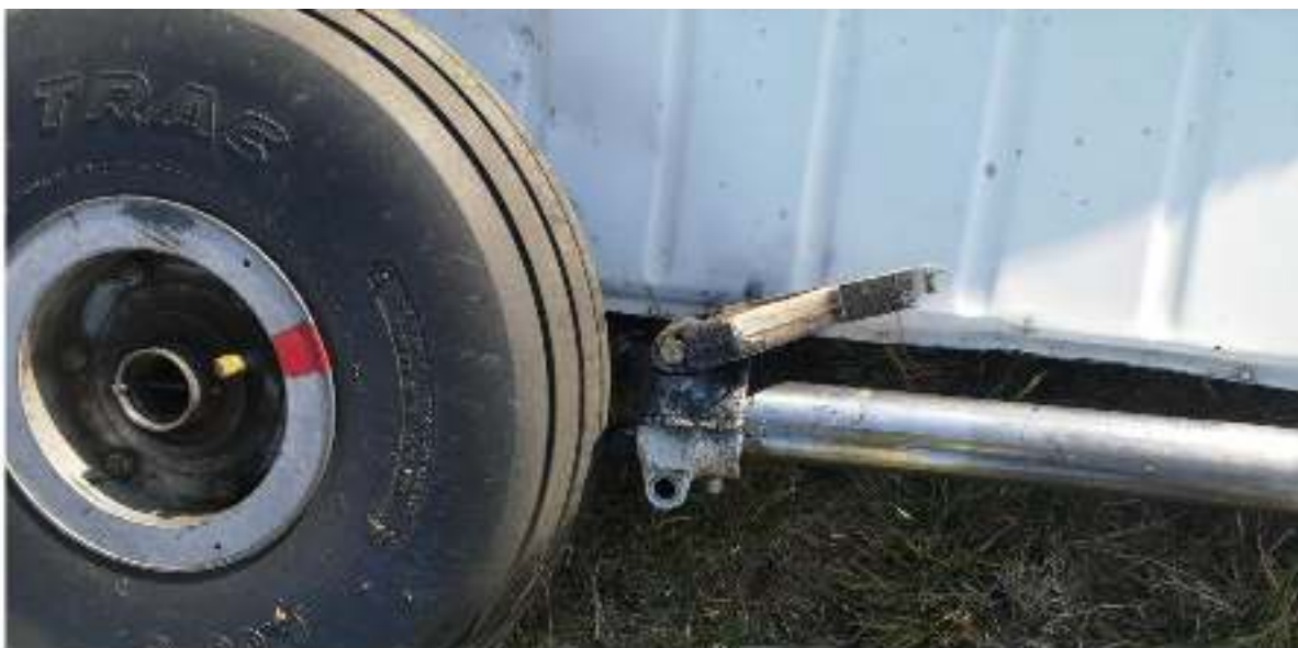
Слика 6. Оштећења стајног трапа авиона
