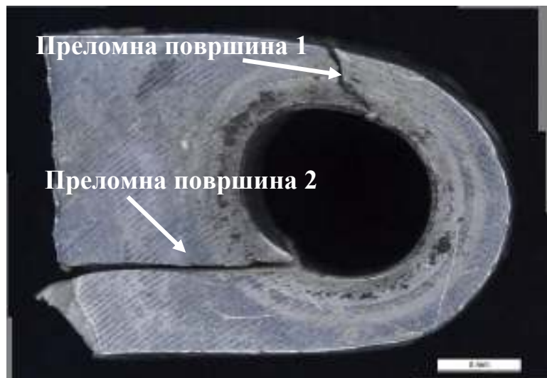
Слика 34. Изглед поломљеног врха маказа 1
