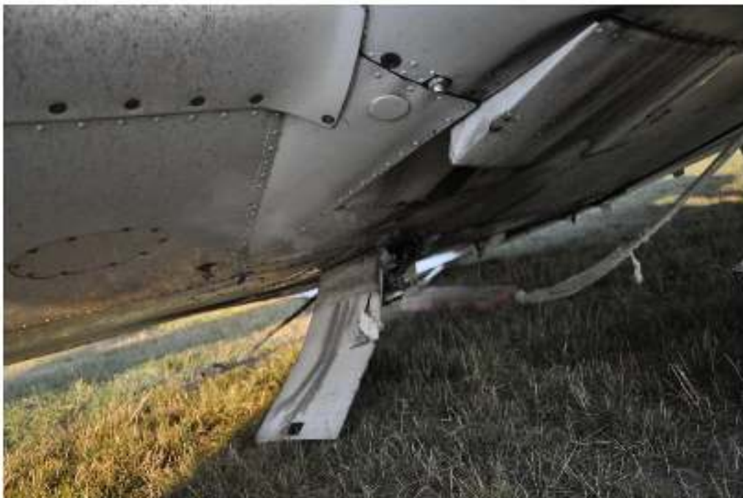
Слика 9. Оплата доњег дела трупа
