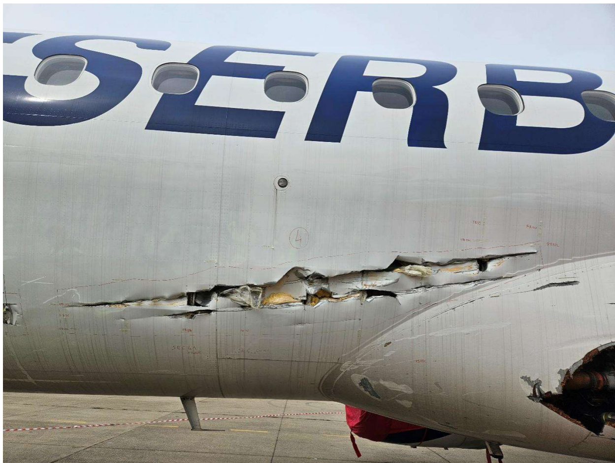
Слика 4. Зона 4 - Лева страна трупа авиона – наставак контакта трупа са аеродромском опремом у зони између преграде 32 и преграде 40 и између уздужница 17Л и 22Л
