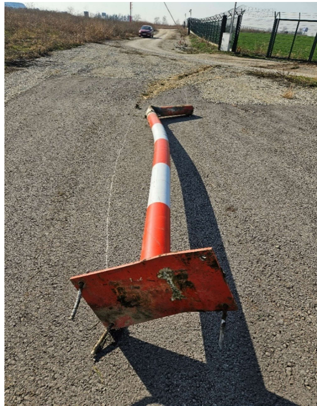
Слика 19. Приказ стуба са антенном/стуб на ком је постављена антена „Far field Monitora“ за RWY 12R пре и након удеса
