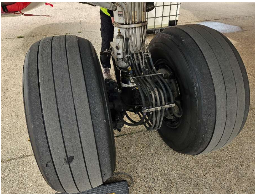
Слика 15. Леви точкови главног стајног трапа са знацима оштећења
