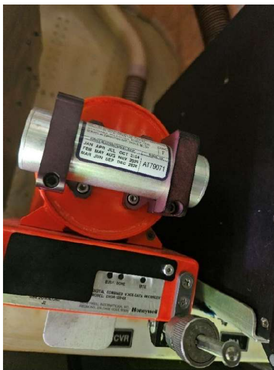
Слика 22. DVDR (Digital Voice Data Recorder) Дигитални снимач гласа и података
