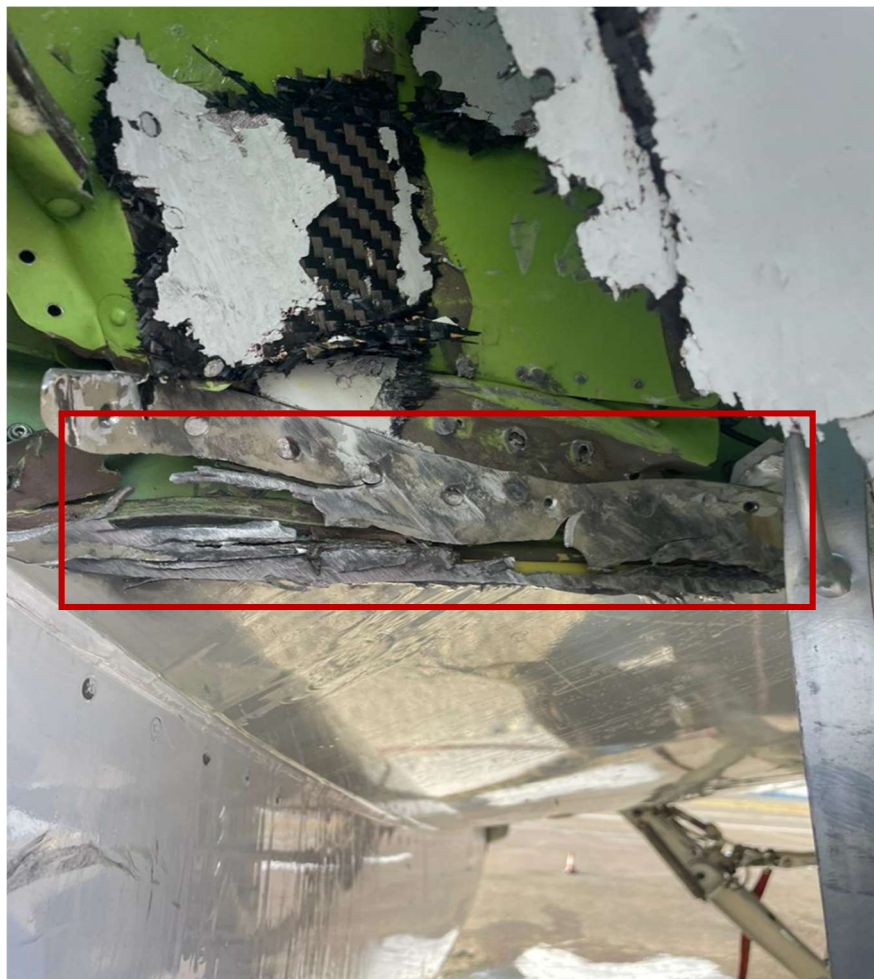
Слика 9. Оштећење везе доњаке крила и предње рамењаче левог крила између ребра 1 и 2 Обележена је зона оштећења кроз који је дошло до цурења горива из левог крилног резервоара
