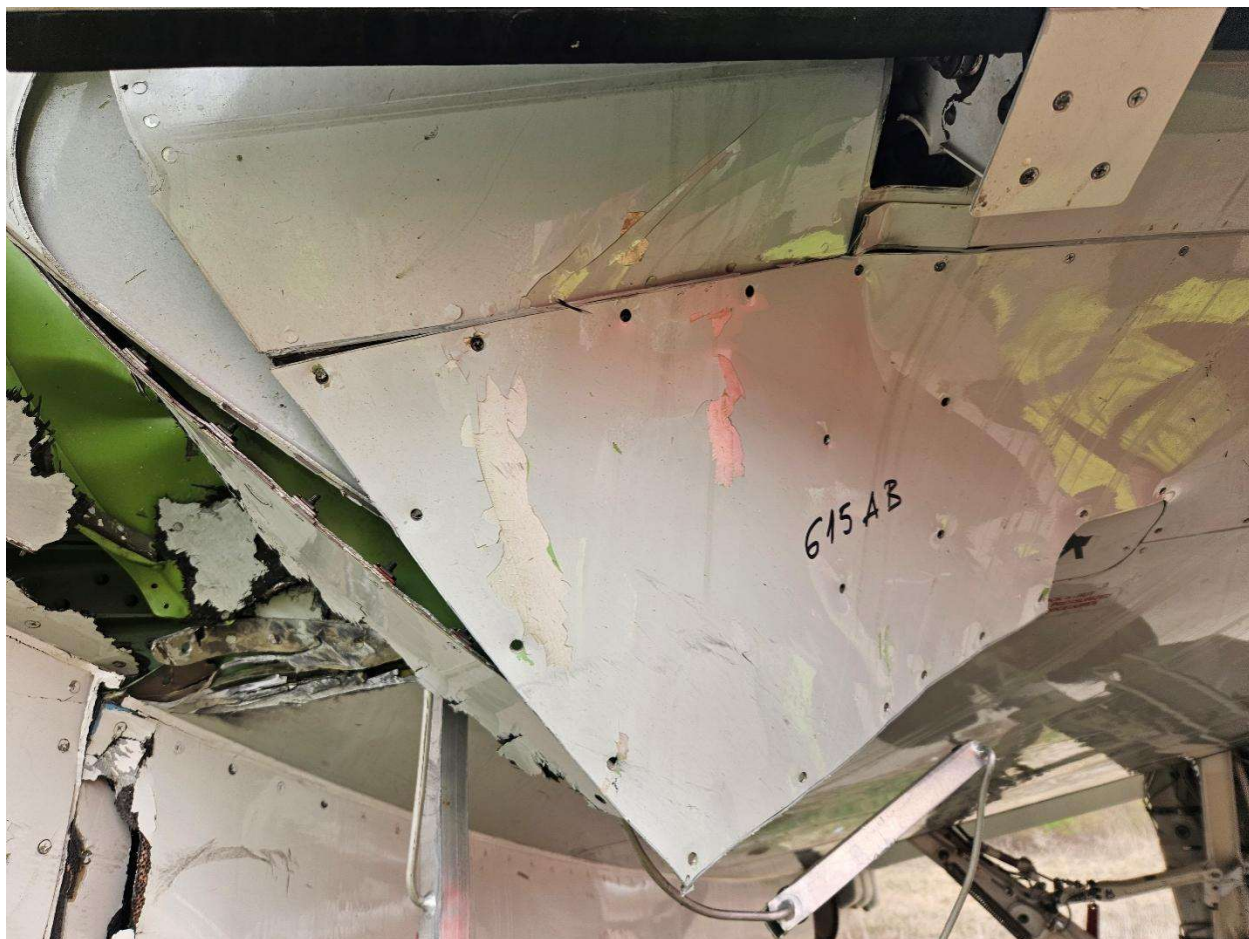
Слика 6. Оштећење доњаке левог крила
