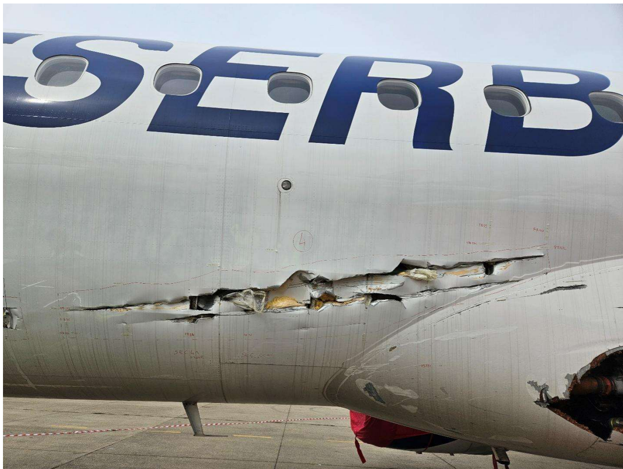
Слика 4. Зона 4 - Лева страна тупа авиона – наставак контакта тупа са аеродромском опремом у зони између преграде 32 и преграде 40 и између уздужница 17Л и 22Л
