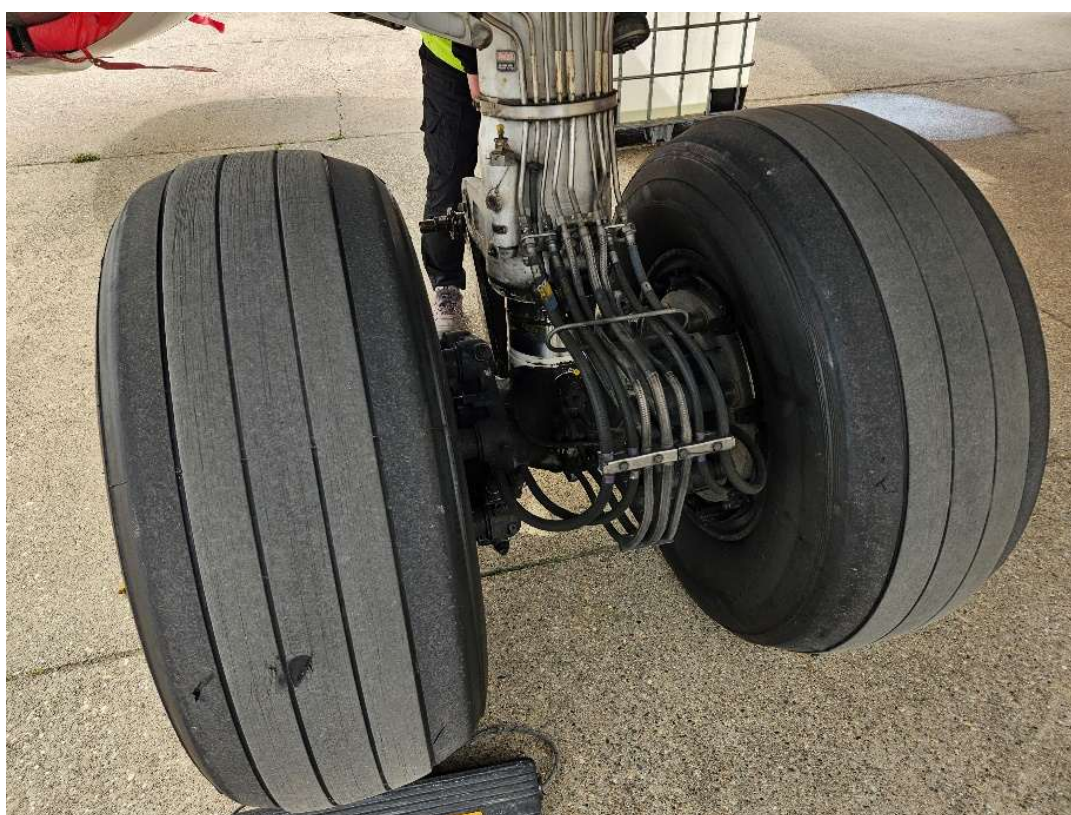
Слика 15. Леви точкови главног стајног трапа са знацима оштећења
