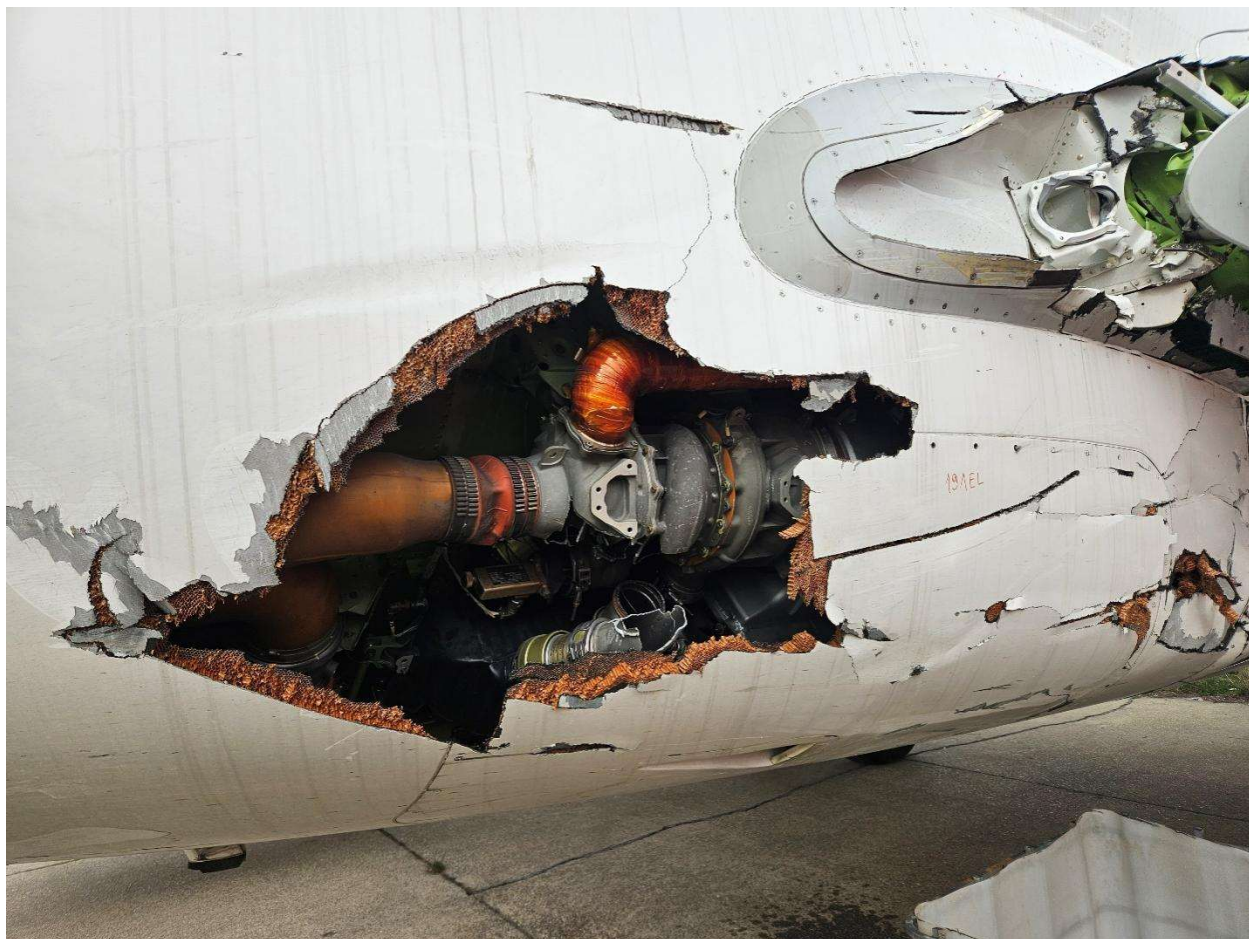
Слика 5. Оштећење композитног панела у доњој зони споја крило-труп
