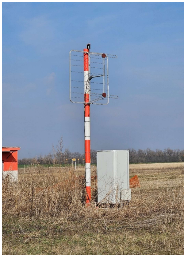
Слика 19. Приказ стуба са антенном/ стуб на ком је постављена антена „Far feeld Monitora“ за RWY 12R пре и након удеса
