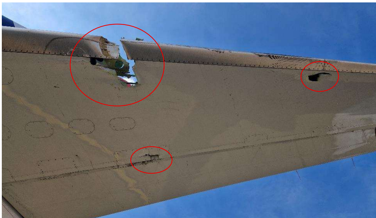
Слика 14. Оштећење нападне ивице између ребра 8 и 9 и доњаке левог хоризонталног стабилизатора
