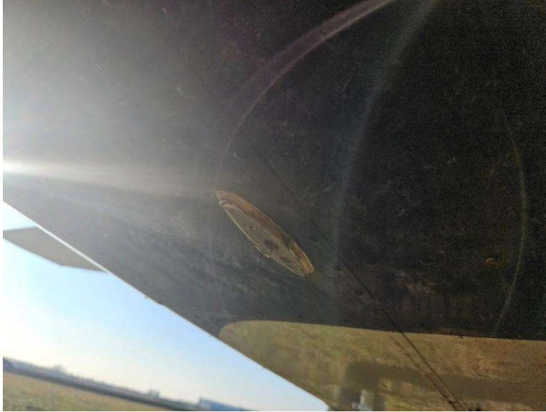
Слика 4. Доњака трупа са местом лома антене
