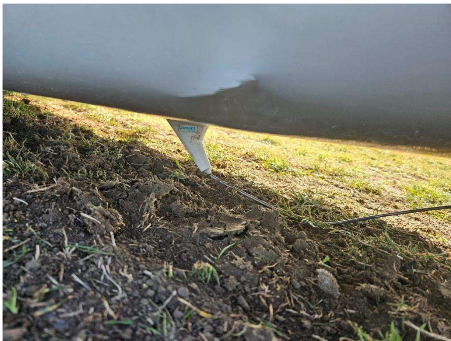
Слика 2. Оштећење структуре задњег дела трупа
