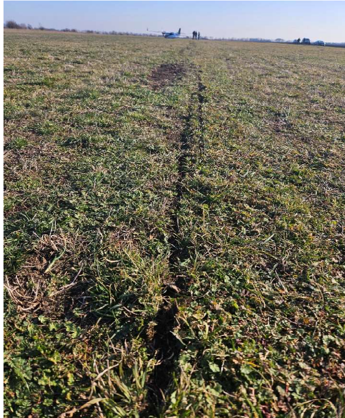
Слика 7. Усеци настали од антена авиона на доњаци трупа
