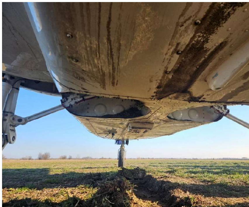
Слика 6. Оштећење доњег дела оплате трупа
