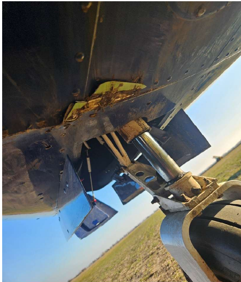
Слика 5. Оштећење доњег дела трупа и оплате иза носне ноге стајног трапа
