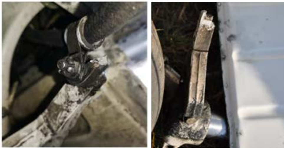
Слика 4. Прелом маказа на нози стајног трапа
