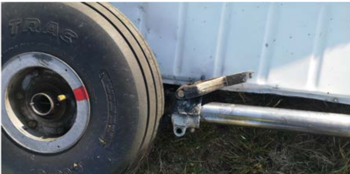
Слика 6. Оштећења стајног трапа авиона
