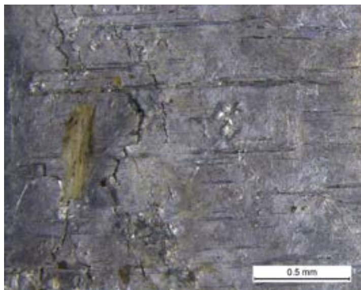
Слика 29. Изглед површине маказа са уоченим оштећењима, шупљинама и прслинама
