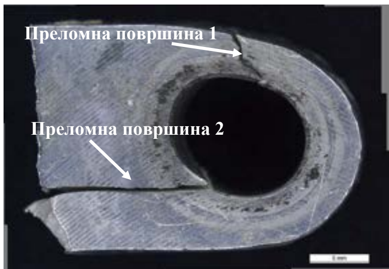
Слика 34. Изглед поломљеног врха маказа 1
