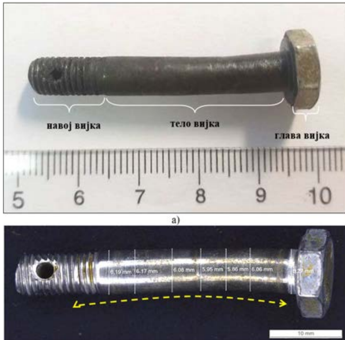
Слика 17. Изглед деформисаног вијка, а) пре и б) после прања.
