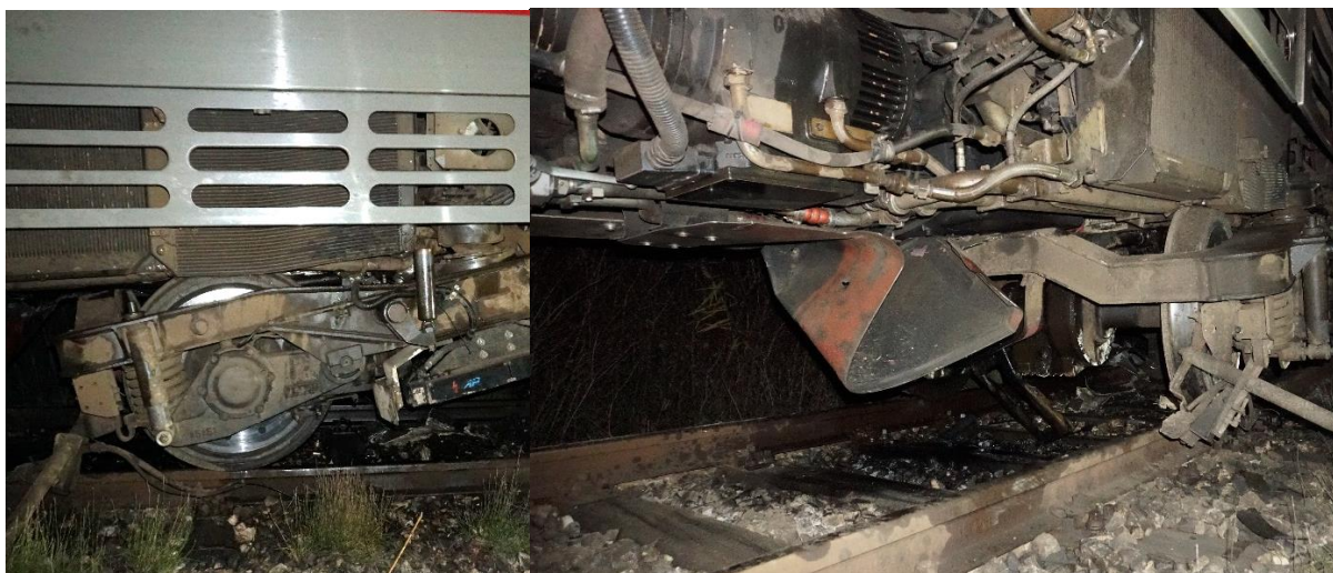
Слика 4.1.1.5: Изглед оштећења на погонској групи ДМВ 711-078
