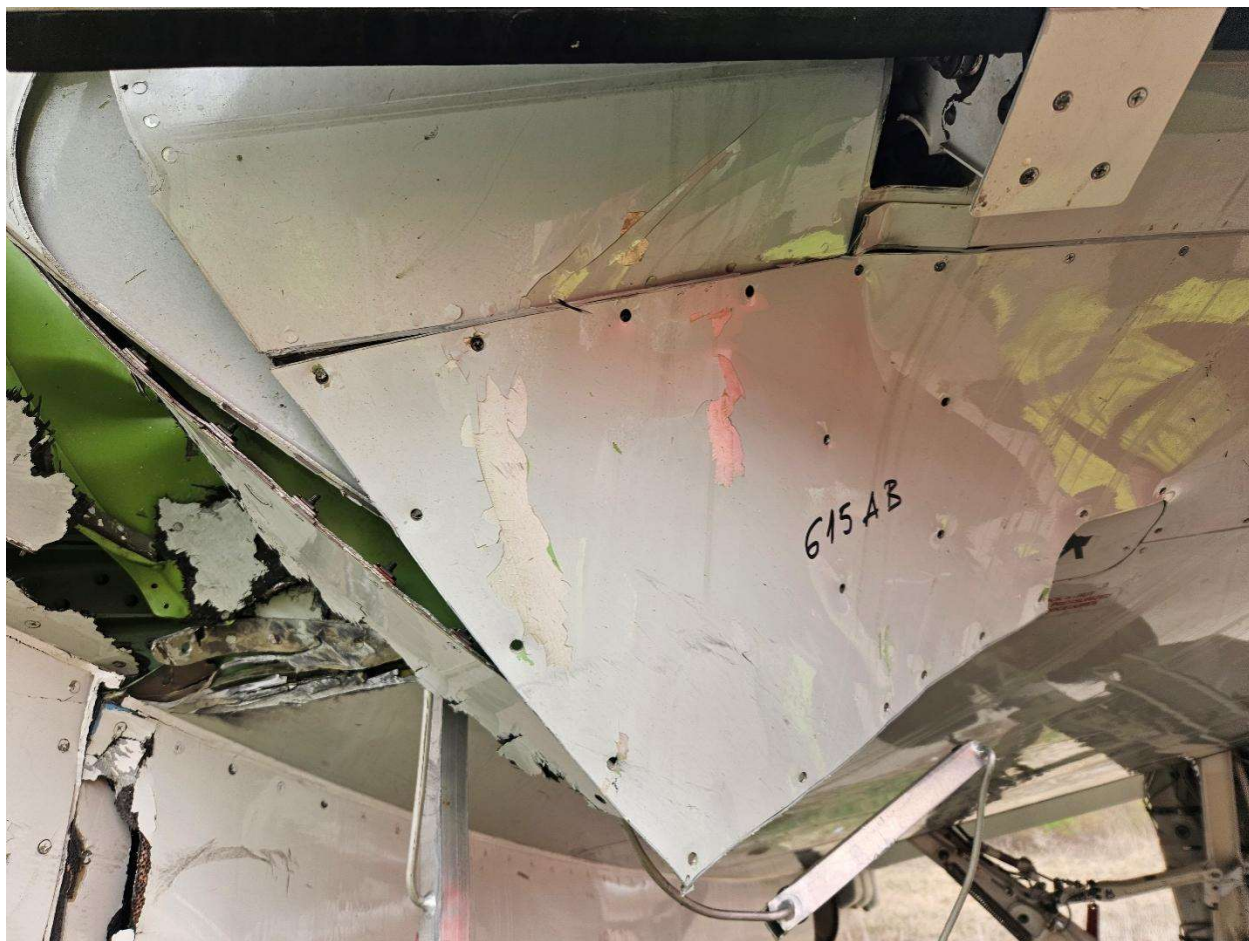
Слика 6. Оштећење доњаке левог крила
