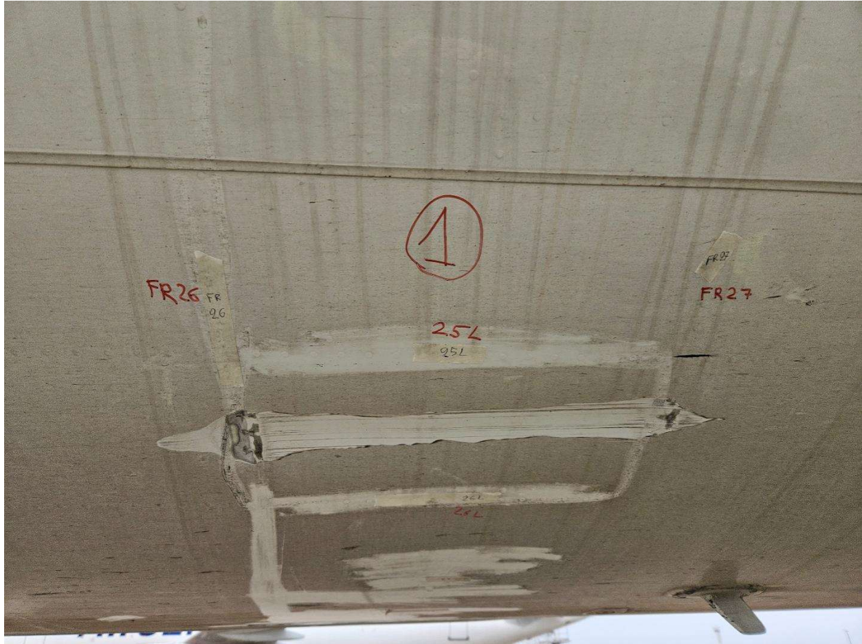
Слика 1. Зона 1 - Лева страна трупа авиона – први контакт трупа са аеродромским светлима у зони између преграде 26 и преграде 27 и уздужнице 25Л
