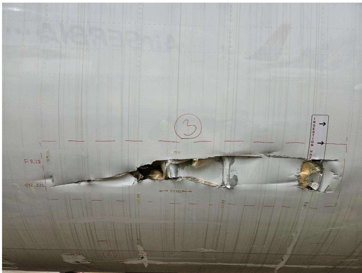
Слика 3. Зона 3 - Лева страна тупа авиона – наставак контакта тупа са аеродромском опремом у зони између преграде 28 и преграде 31 и уздужнице 22Л
