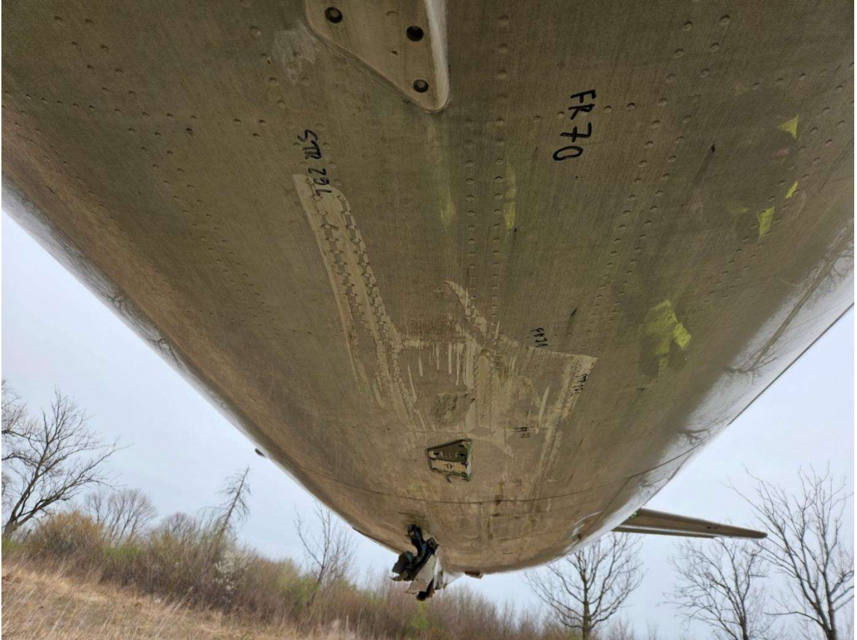
Слика 11. Оштећење доњаке трупа у зони од преграде 75 до преграде 75 између уздужница 27Л и 29Р
