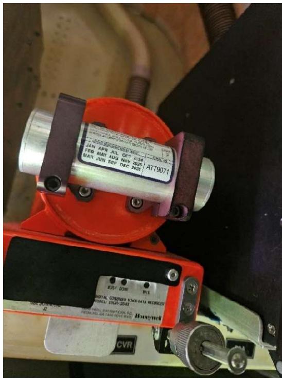
Слика 22. Дигитални снимач гласа и података (DVDR - Digital Voice Data Recorder)
