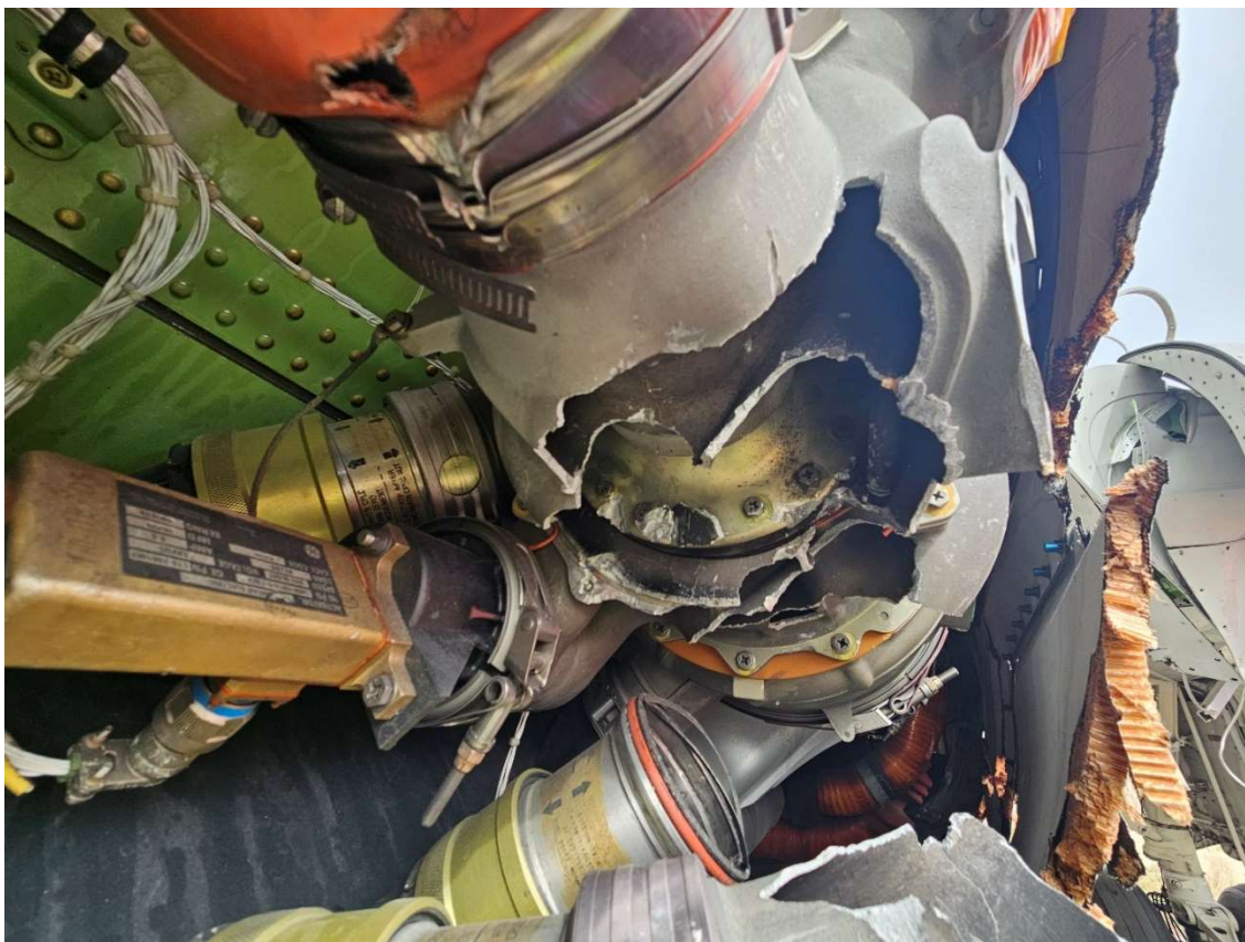
Слика 12. Оштећење левог система за климатизацију
