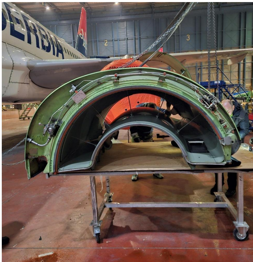
Слика 7. Контрапотисак након демонтаже
