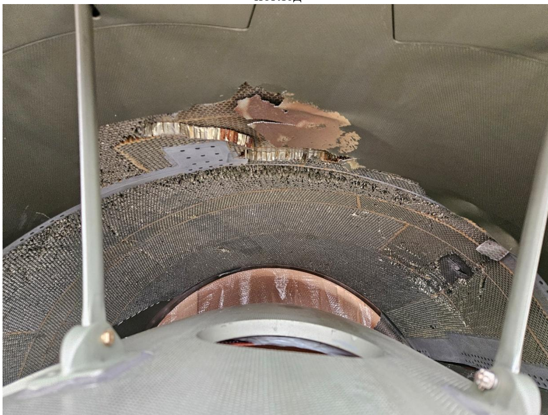
Слика 3. Оштећење саћасте структуре и унутрашње оплате контрапотисника – цела површина
