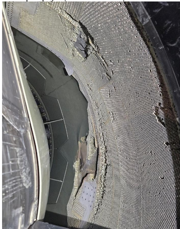
Слика 12. Поглед на оштећену зону контрапотисника левог мотора у тренутку увиђаја
