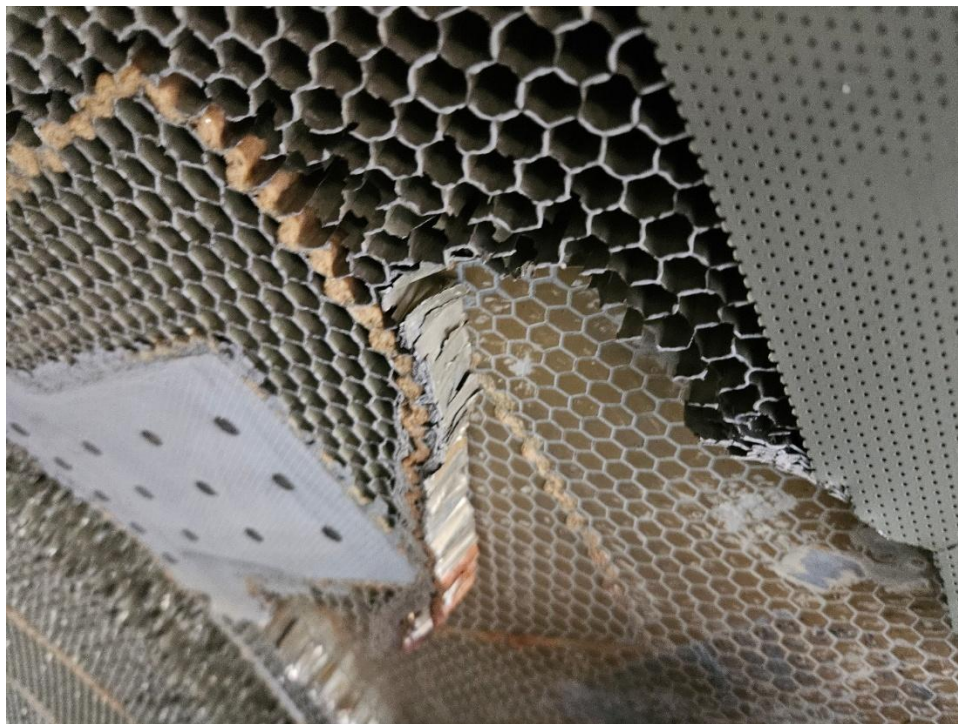
Слика 1. Оштећење саћасте структуре контрапотисника левог мотора – зона оправке
