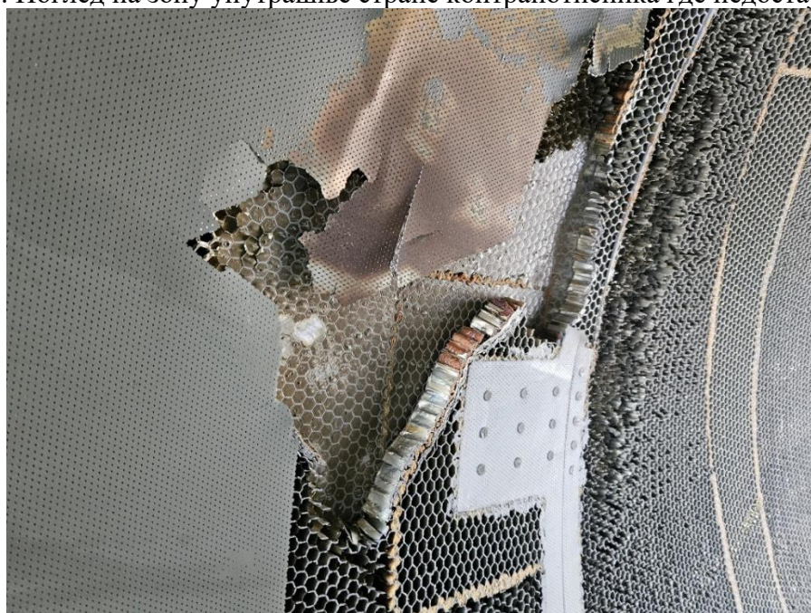
Слика 5. Поглед на зону почетака одвајања оправке
