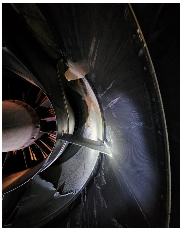
Слика 12. Поглед на оштећену зону контрапотисника левог мотора у тренутку увиђаја
