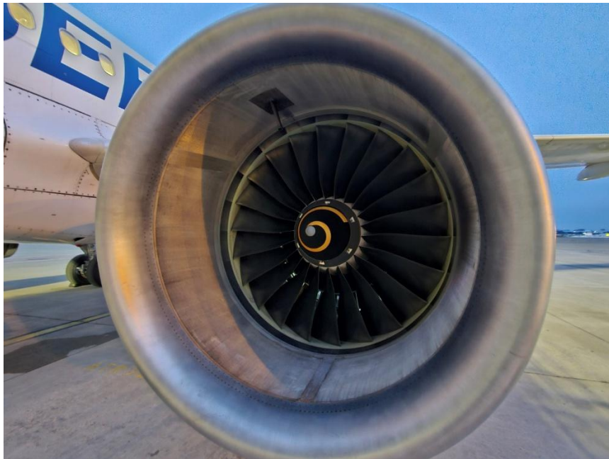
Слика 10. Поглед на уводник мотора број 1 (без оштећења)
