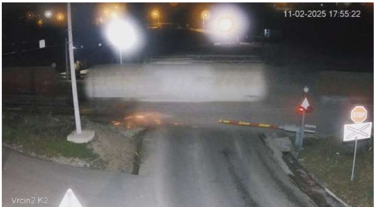
Слика 4.2.9.2: Варничење од удара исклизлих точкова једанаестог вагона о подлогу (извор „ИЖС“ а.д.)
