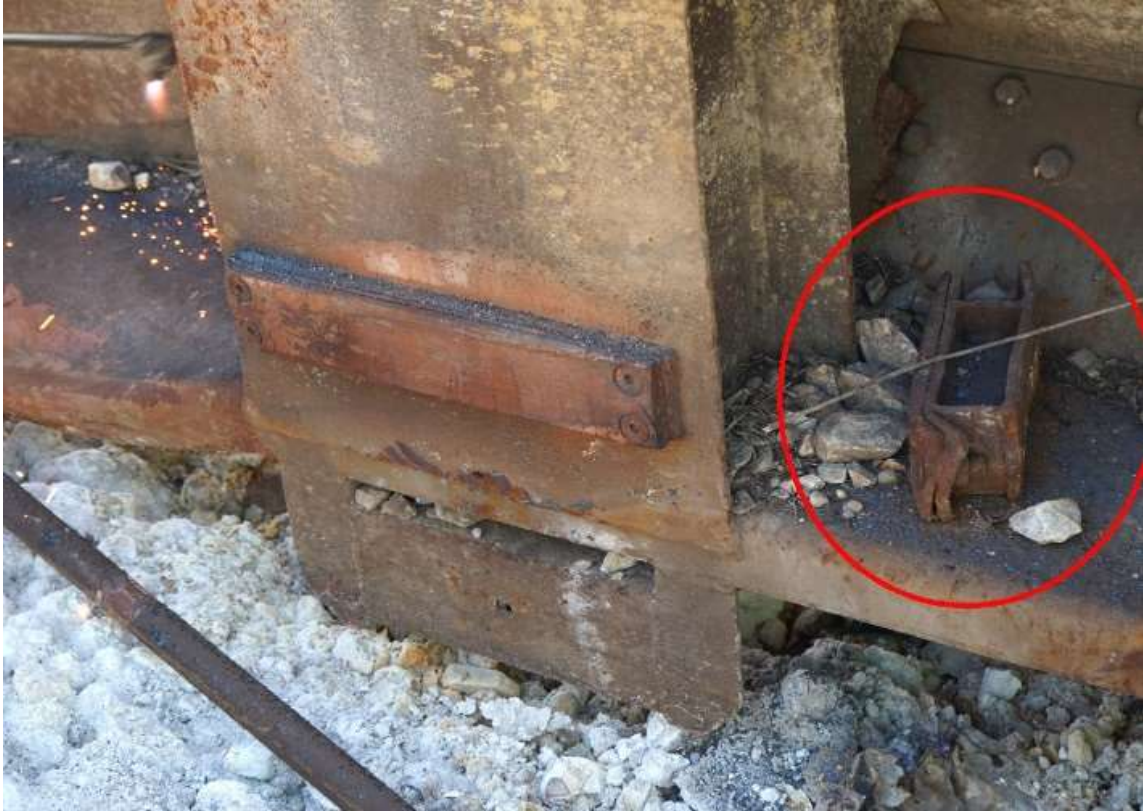
Слика 4.2.13.6: Положај откинутог доњег поклизника
