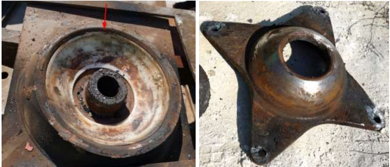
Слика 4.2.13.1: Доња и горња обртна шоља задњег обртног постоља
