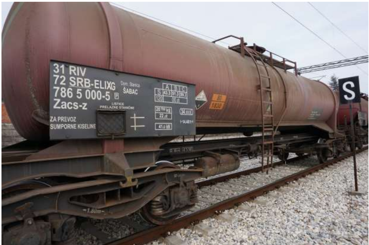
Слика 2.2.2.1: Изглед вагона-цистерне серије Z за превоз сумпорне киселине
