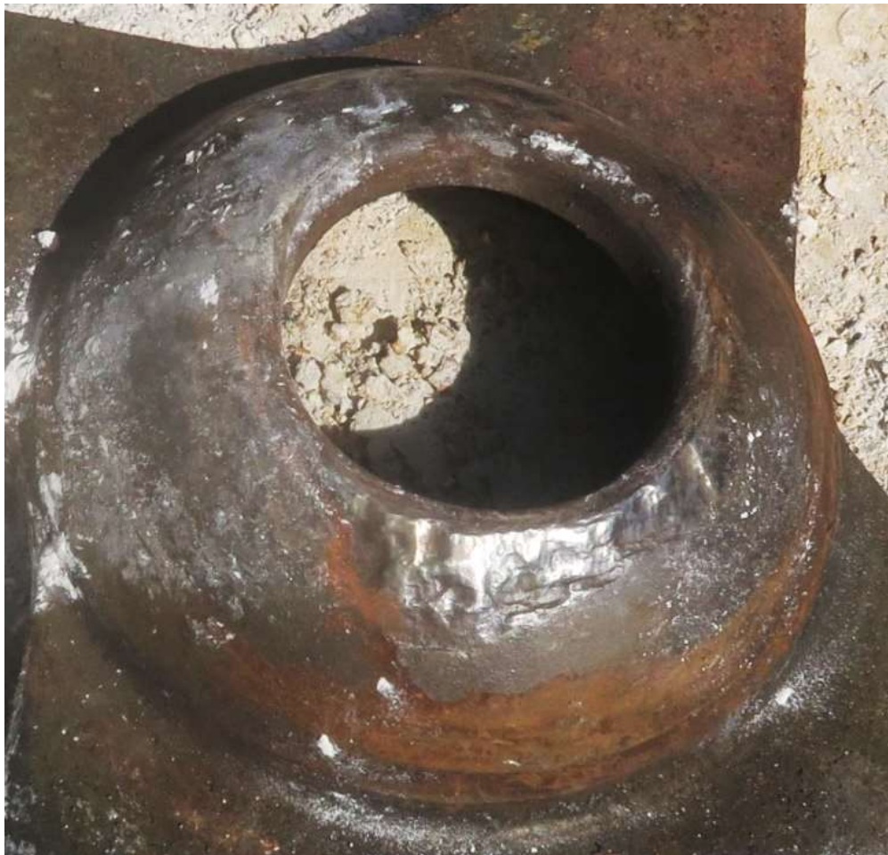
Слика 4.2.13.4: Горња обртна шоља предњег обртног постоља
