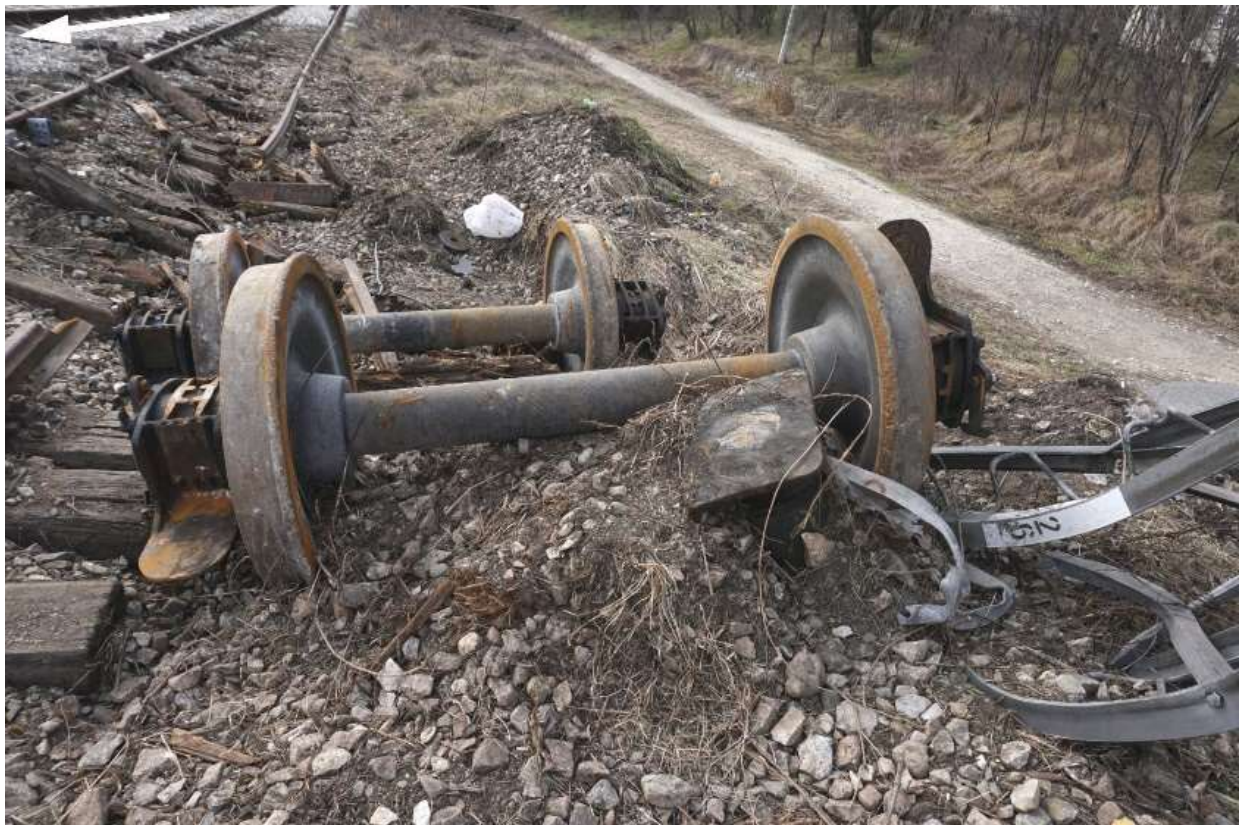
Слика 4.2.10.4: Испали осовински склопови и одбојник једанаестог вагона
