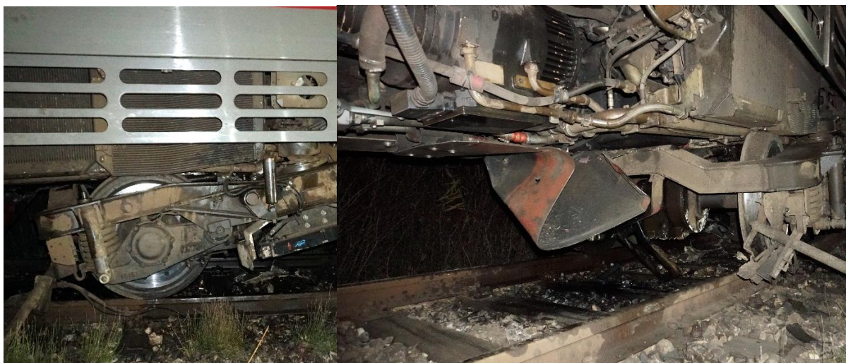
Слика 3.1.5: Изглед оштећења на погонској групи ДМВ 711-078
