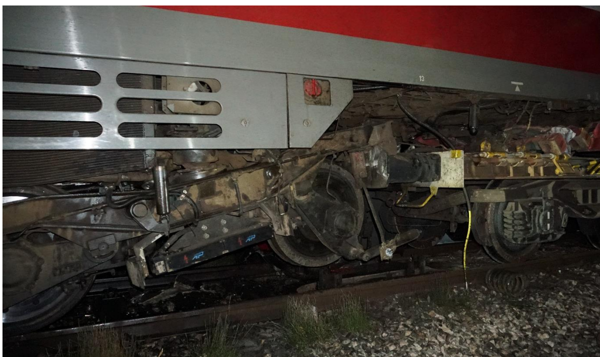
Слика 3.1.4: Изглед помереног обртног постоља на ДМВ 711-078
