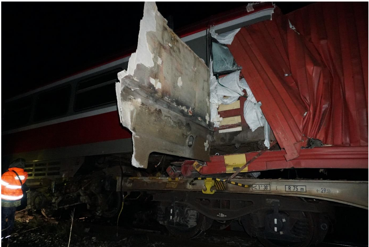
Слика 3.1.2: Изглед оштећења на предњем делу сандука ДМВ 711-078 и контејнеру број CNEU 453486-3
