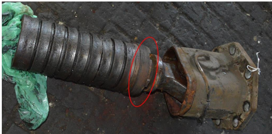
Слика 4.2.3.1: Извучени склоп вучне мотке (заокружен навојни део) демонтиран са приколице 416-004
