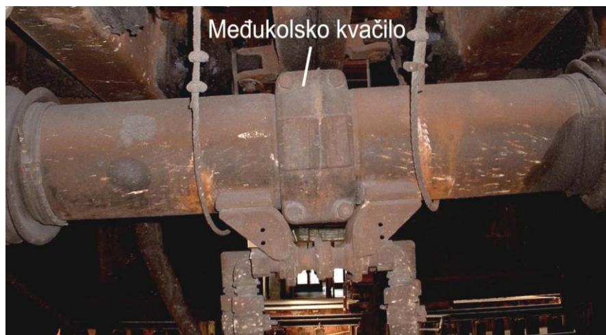
Слика 2.2.2.2: Изглед међуколског квачила уграђеног на ЕМВ серије 412/416
