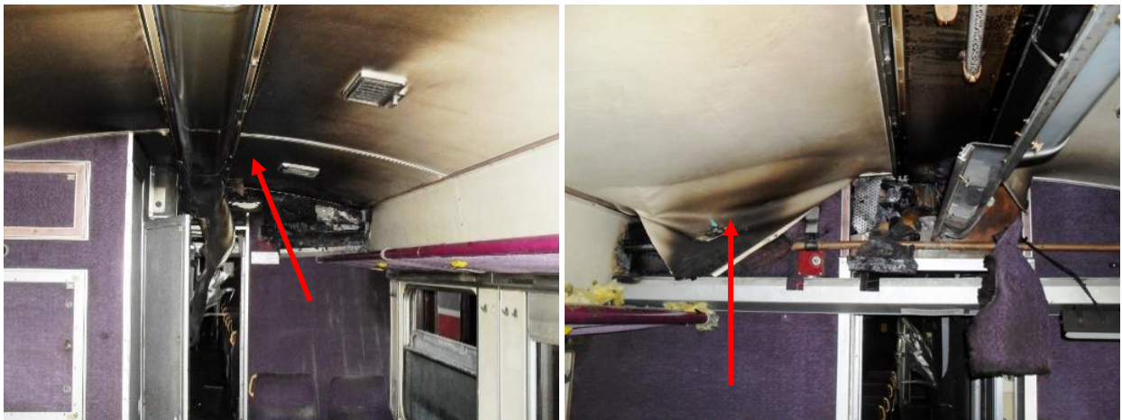
Слика 4.1.1.7: Трагови пожара у унутрашњем делу ДМК
