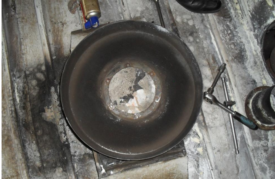
Слика 4.1.1.17: Изглед поклопца заштитне цеви ДМ „А“ са траговима гаражи са унутрашње стране
