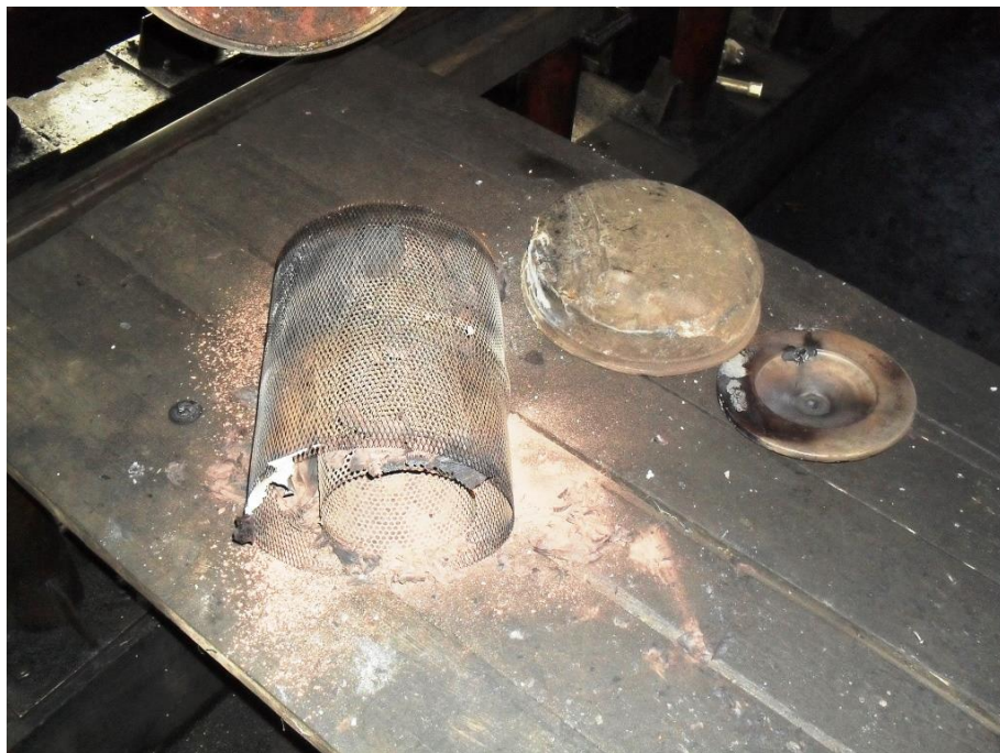
Слика 4.1.1.5: Изглед унутрашњих делова филтера ваздуха ДМ „А“
