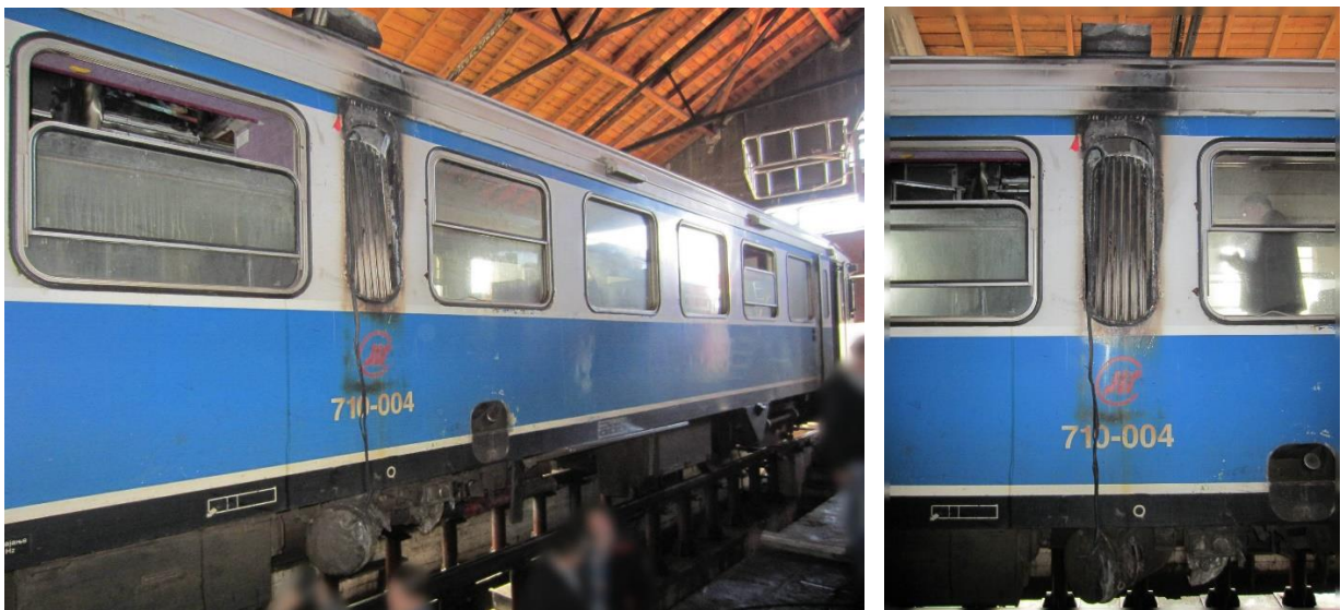
Слика 3.4.4.1: Изглед ДМК 710-004 захваћен пожаром (средишњи део споља)
