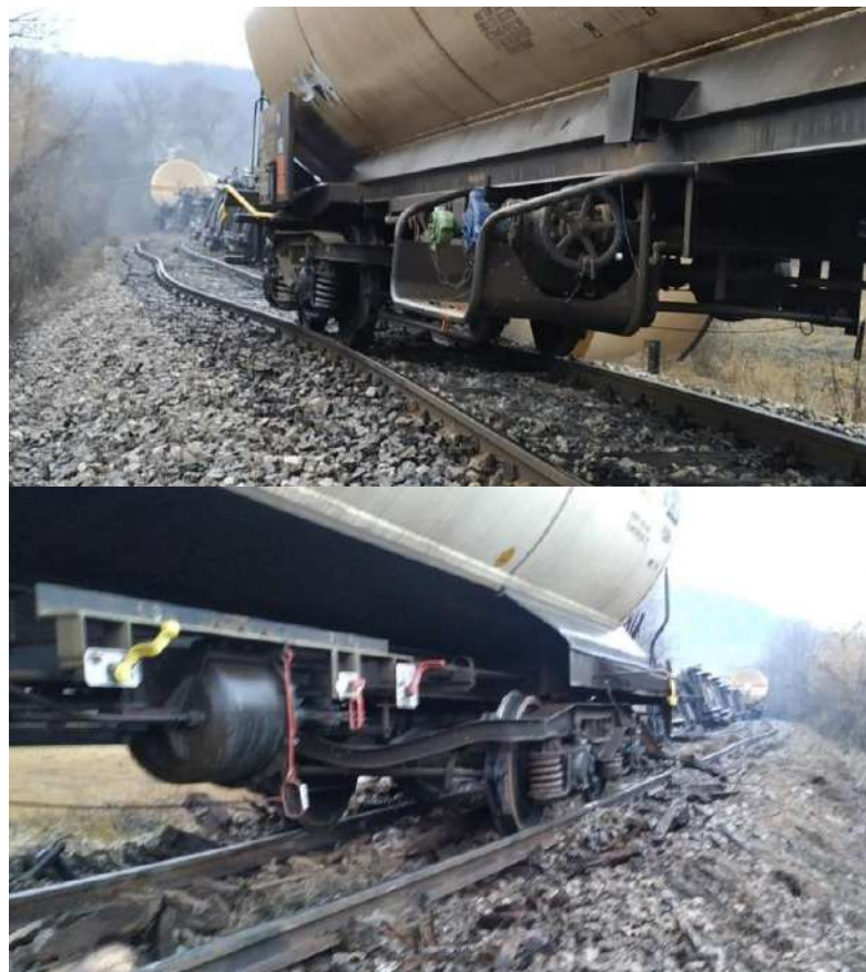
Слика 3.4.4.2: Изглед исклизлих деветих (горе) и четрнаестих кола (доле) (извор: „ИЖС“ а.д.)
