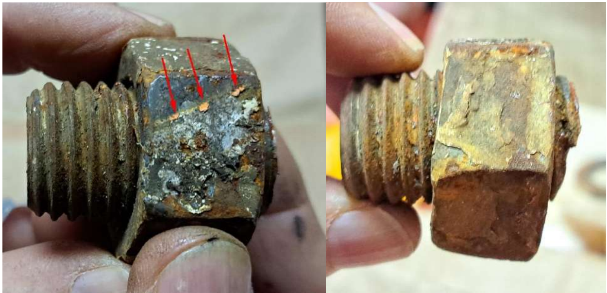
Слика 4.2.1.11: Изглед пронађених откинутих вијака
