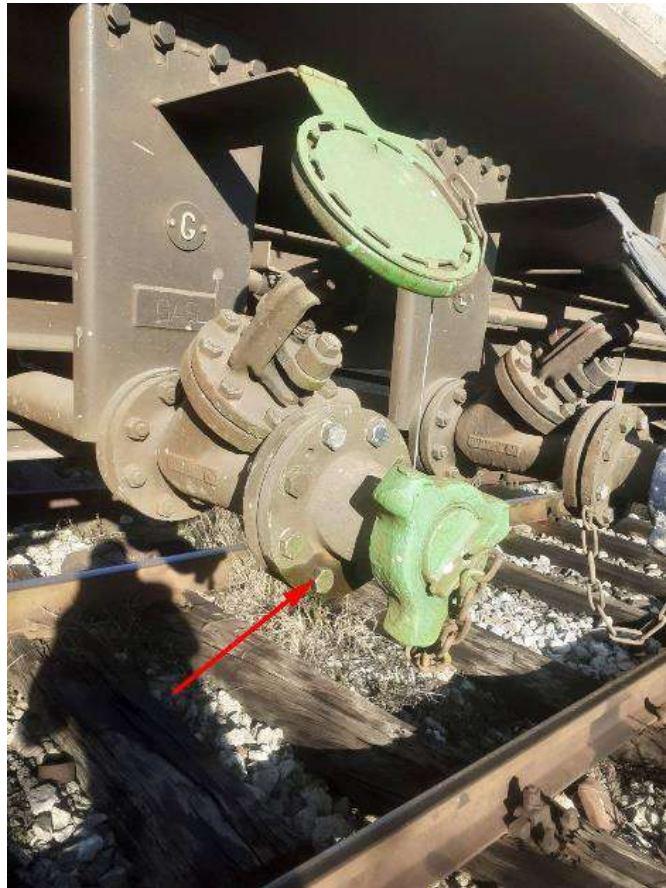
Слика 4.2.5.2.2: Место цурења амонијака на осмим колима број 33 80 7818 092-8
