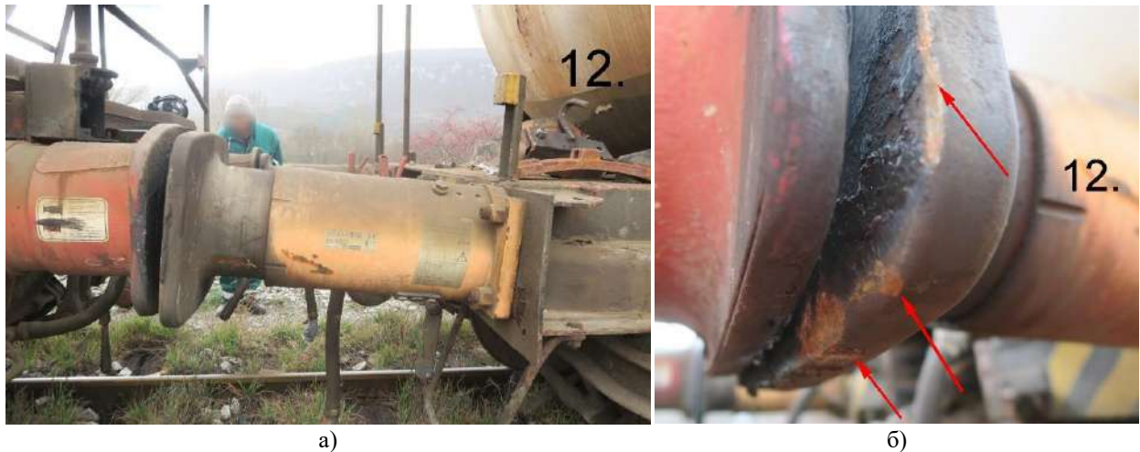
Слика 4.2.1.10: Повијен одбојник и трагови на одбојничкој плочи дванаестих кола
