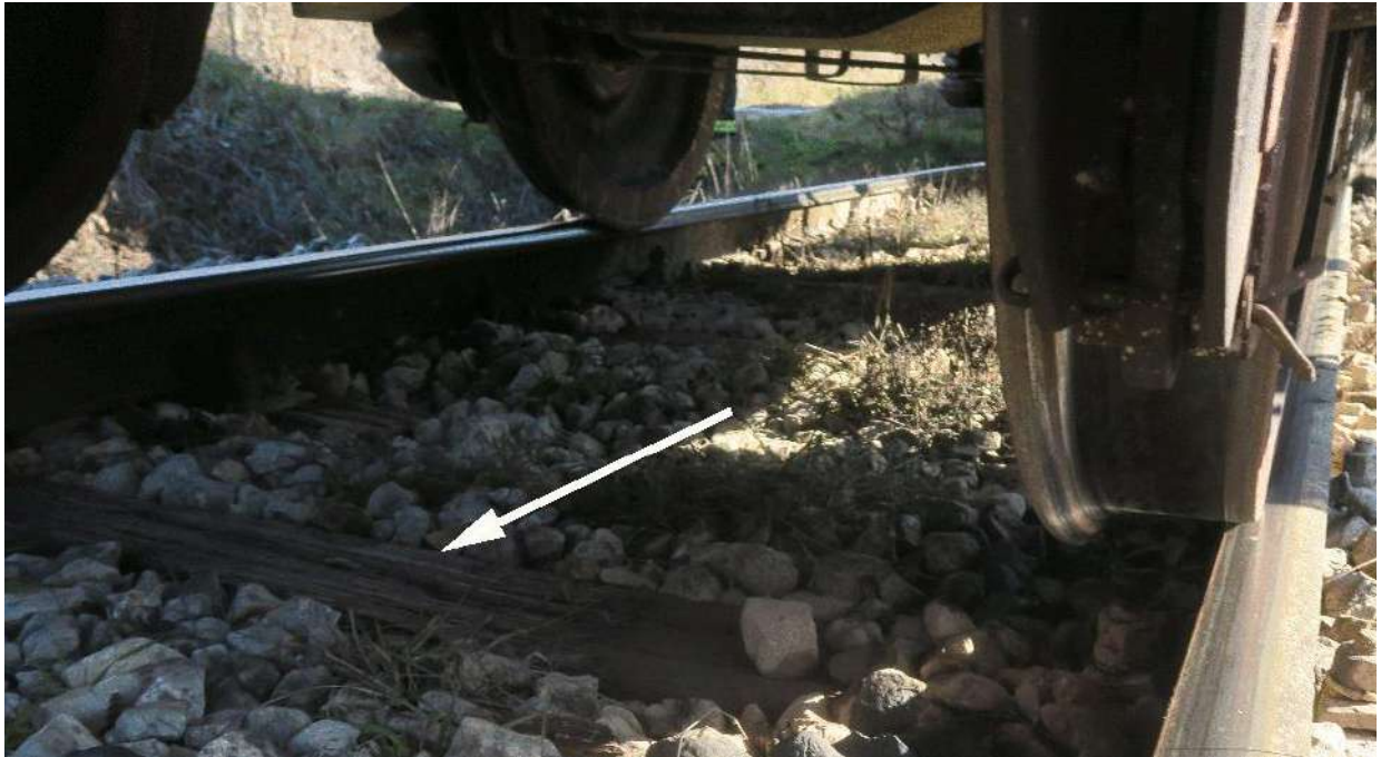
Слика 4.2.1.15: Положај на шини левог точка треће осовине седамнастих кола
