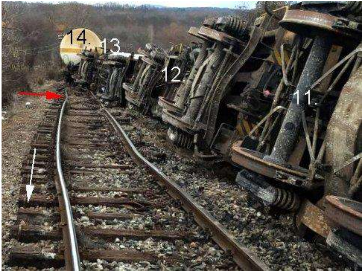
Слика 4.2.1.7: Деформација колосека у зони предњег обртног постоља тринаестих кола
