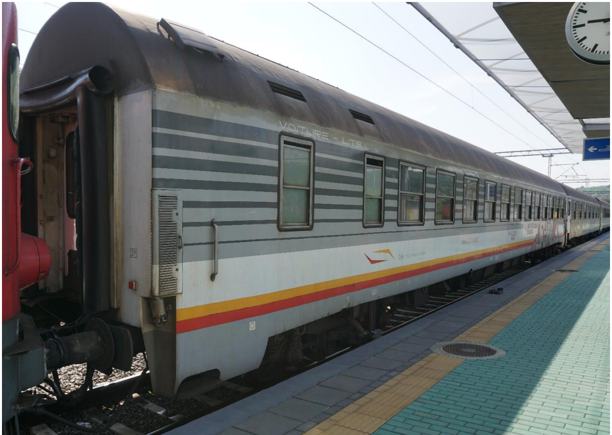
Слика 2.2.2.2: Изглед WLABlm кола - спаваћа кола број 50 62 72-10 510-3
