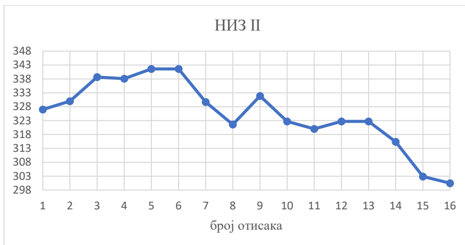
Слика 45. Дијаграм расподеле микротврдоће на узорку В1- уздужни правац
