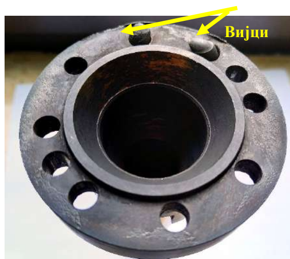
Слика 11. Врх вратила- прстен који се спаја са колом за убризгавање
