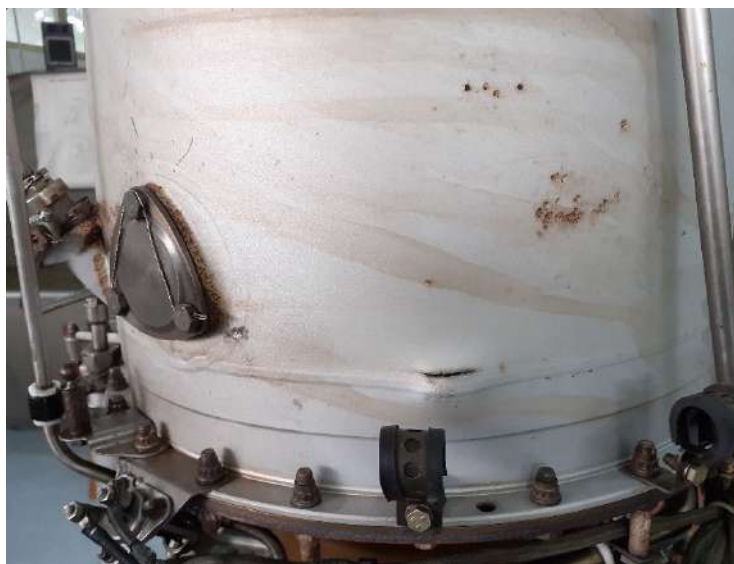
Слика 3 б. Оштећење на оплати коморе сагоревања
