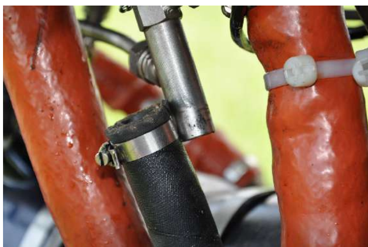
Слика 4. Цев за одушивање мотора је извучена из дуритног цева хеликоптера
