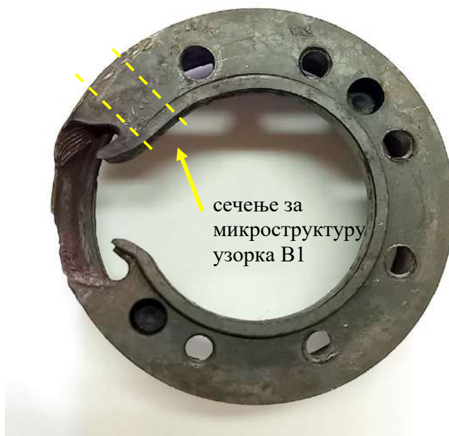
Слика 37. Узорак „вратило турбине мотора“– ознака узорка В. Место сечења за микроструктуру
