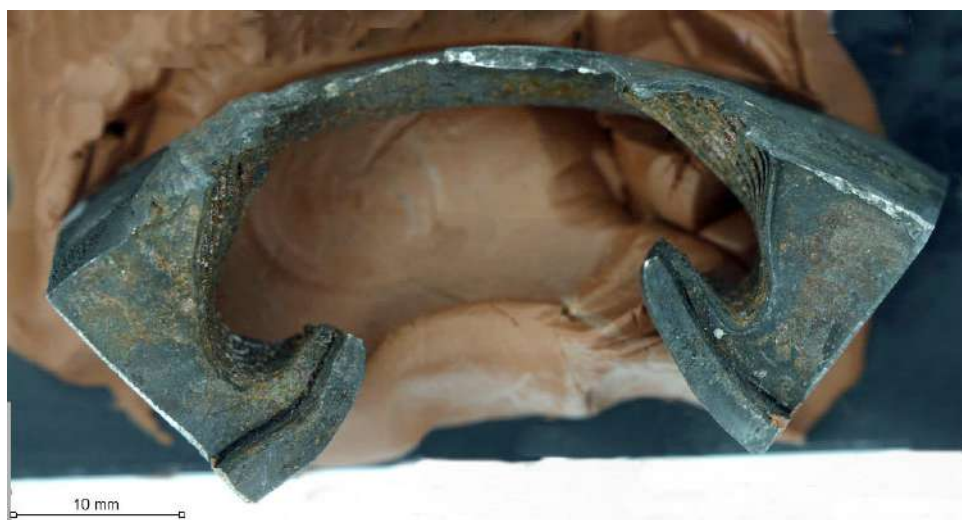
Слика 11. Макрофрактографска анализа лома узорка А „коло за убризгавање“ на СЕМ - поглед одозго
