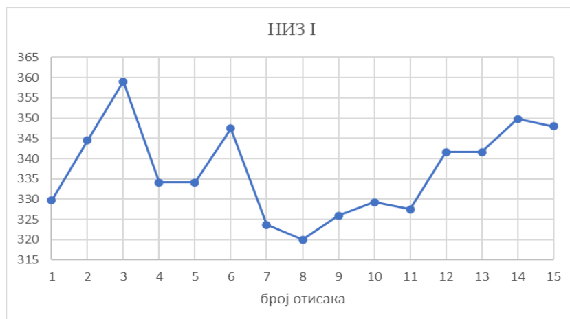
Слика 42. Дијаграм расподеле микротврдоће на узорку Б1- уздужни правац
