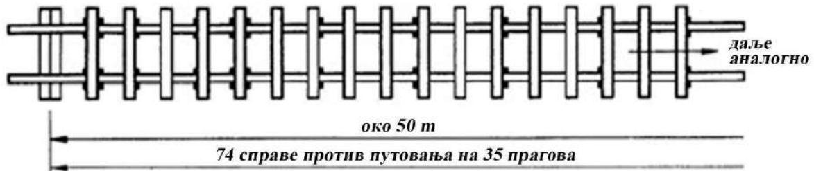
Слика 3.4.2.5: Начин уградње справа против путовања шина
