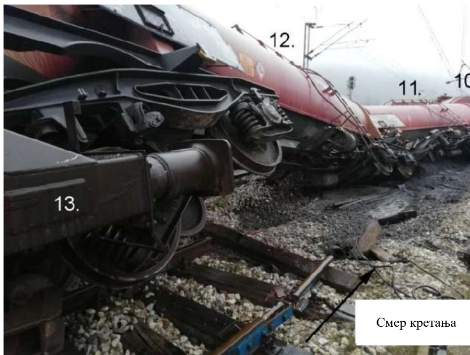
Слика 4.2.1.12: Почетак разореног колосека код изолованог састава у km 123+660,80 и зона највећег изливања киселине
