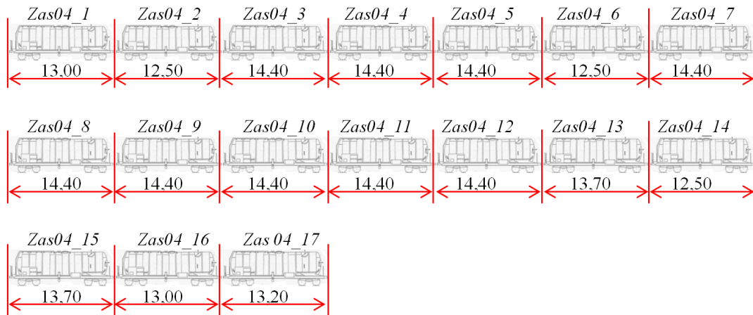
Слика 4.2.3.2: Шема воза број 45022 са дужинама кола
