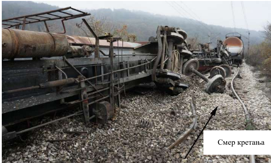
Слика 4.2.1.5: Деформисани леви колосек
