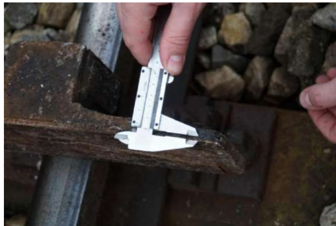
Слика 4.2.2.1.3: Неметални уметак доњег поклизника обртног постоља кола број 33 72 7867 846-7 истрошен до металног носача
