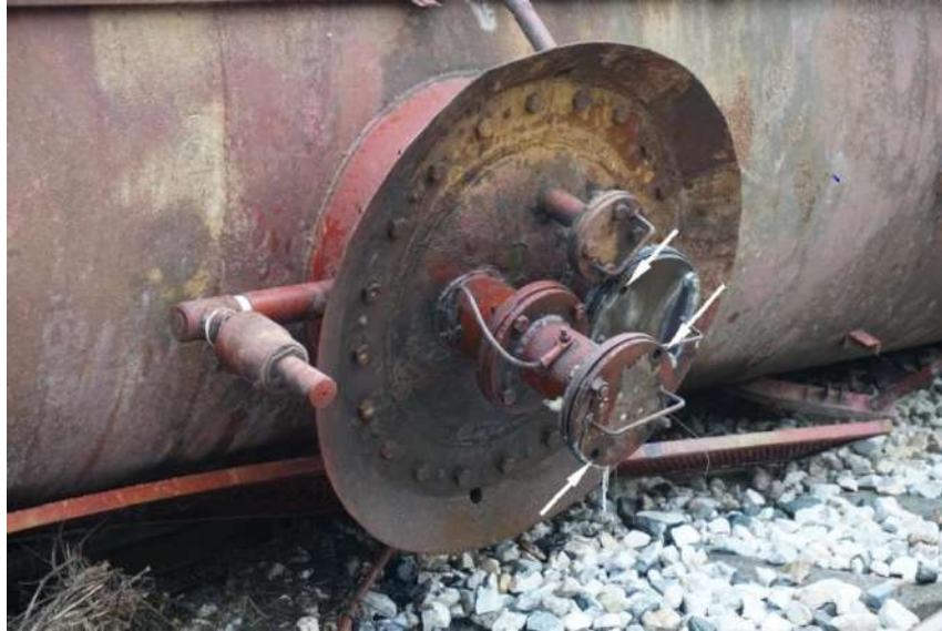
Слика 4.2.1.3: Цурење сумпорне киселине из кола број 31 72 7865 013-8
