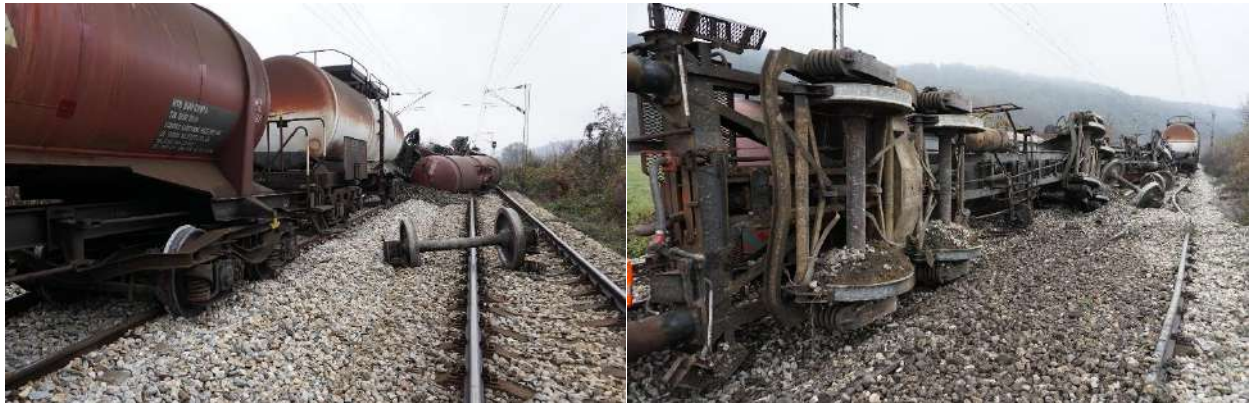
Слика 3.4.4.1: Изглед исклизлих и превнутих кола
