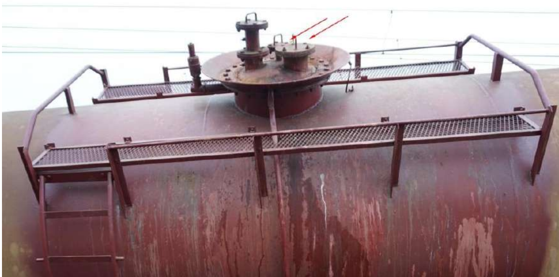
Слика 4.2.1.11: Недостатак вијака на поклопцу дванаестих кола број 31 72 7865 010-4
