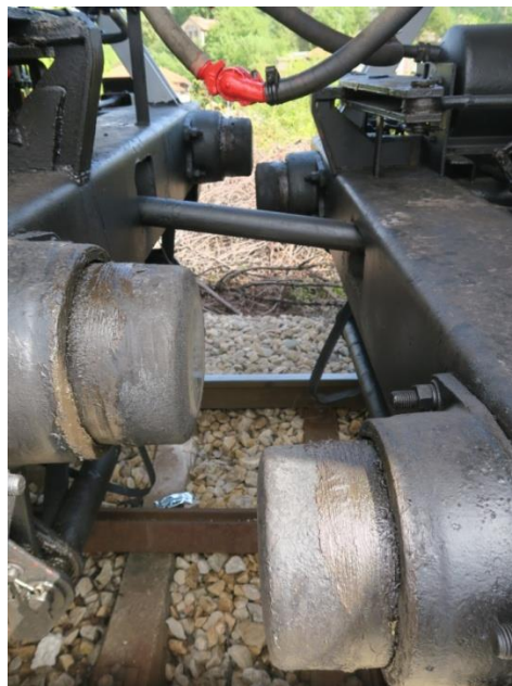
Слика 4.1.3.3: Положај вучно-одбојних уређаја између чланака кола серије Faboo број 43 72 6531 273-0 после исклизнућа
