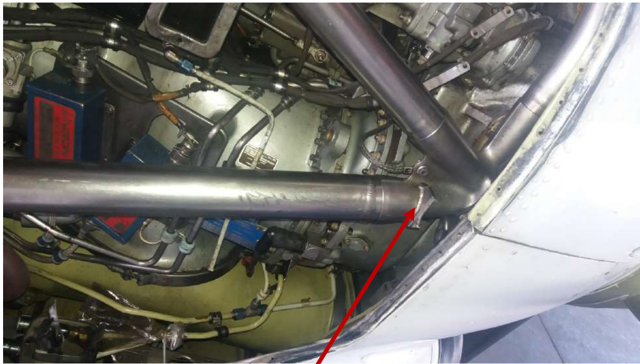
Оштећење цеви мотора и носача мотора бр. 1 Слика 1.
