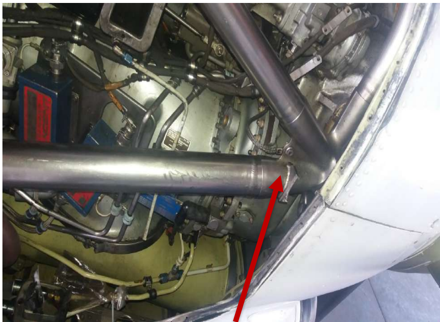
Слика 8. (део механизма браве након лома) (на носачу мотора)
