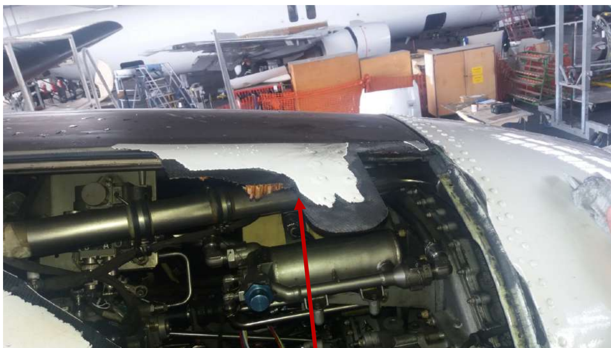
Оштећење горњег поклопца мотора бр. 1 Слика 4.
