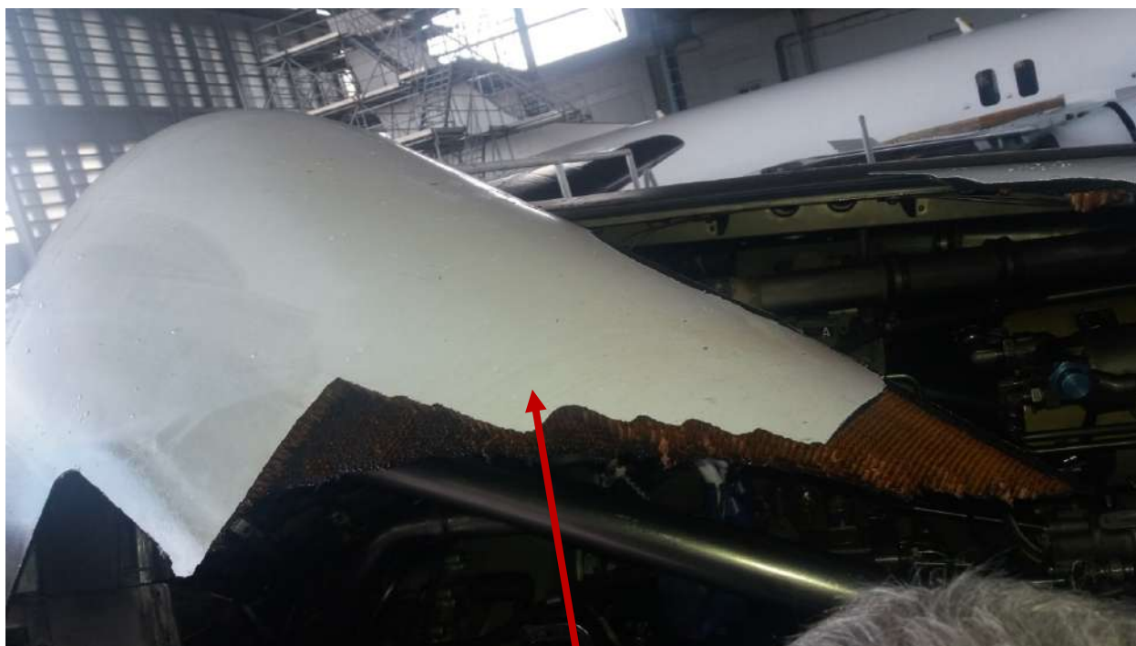
Оштећење десног бочног поклопца мотора бр. 1 Слика 2.
