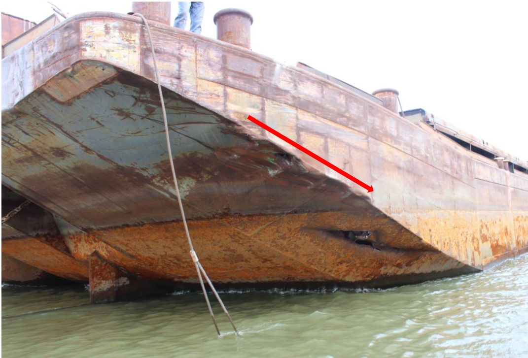
Слика 2.2.6. Пластична деформација руба оплате трупа означена је црвеном стрелицом
