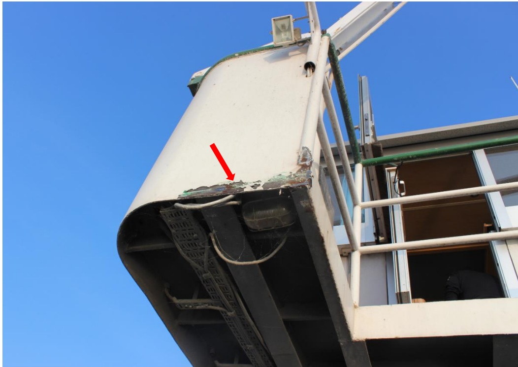
Слика 2.1.4. Уздужна деформација на командном мосту означена је црвеном стрелицом
