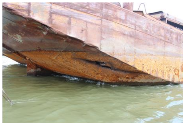
Слика 5.3.3. Приказ дела оштећења на моторном теретном броду „NINA” (лево) и оштећења потиснице регистарске ознаке „UPD-1616” (десно)
