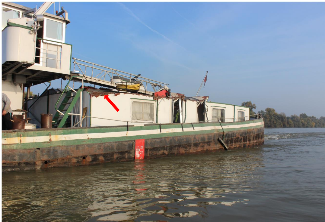
Слика 2.1.5. Оштећена надградња стамбеног простора означена је црвеном стрелицом
