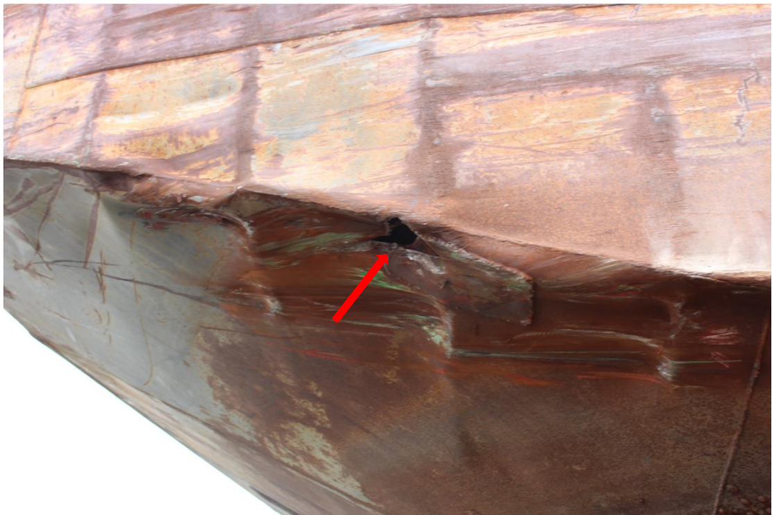
Слика 2.2.4. Пробој оплате трупа означен је црвеном стрелицом
