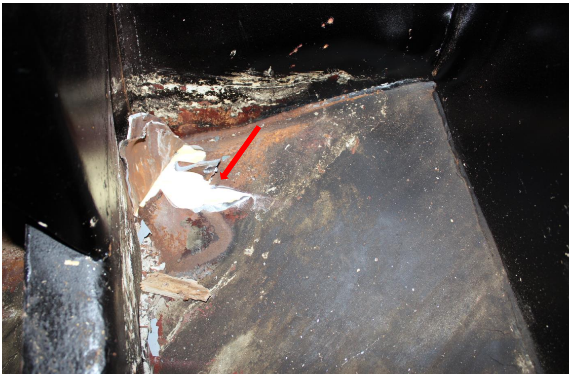
Слика 2.2.5. Пробој оплате трупа означен је црвеном стрелицом
