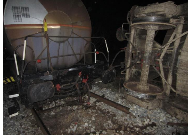
Слика 3.4.4.5: Изглед исклизлих и преврнутих кола
