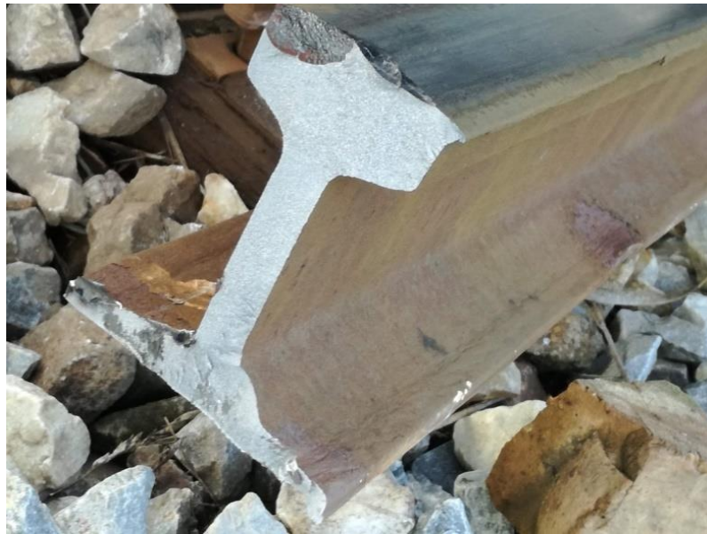
Слика 4.2.4.7: Изглед лома шине на месту несреће
