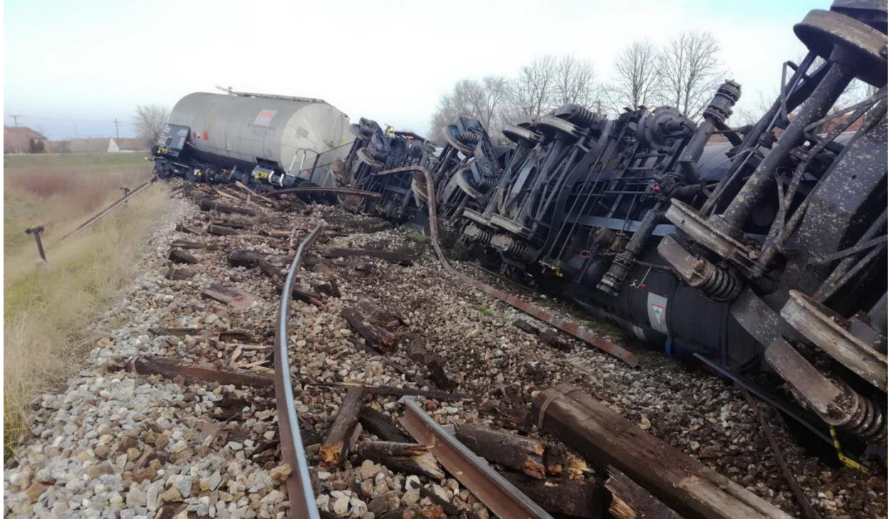
Слика 3.4.4.1: Изглед исклизлих и превнутих кола
