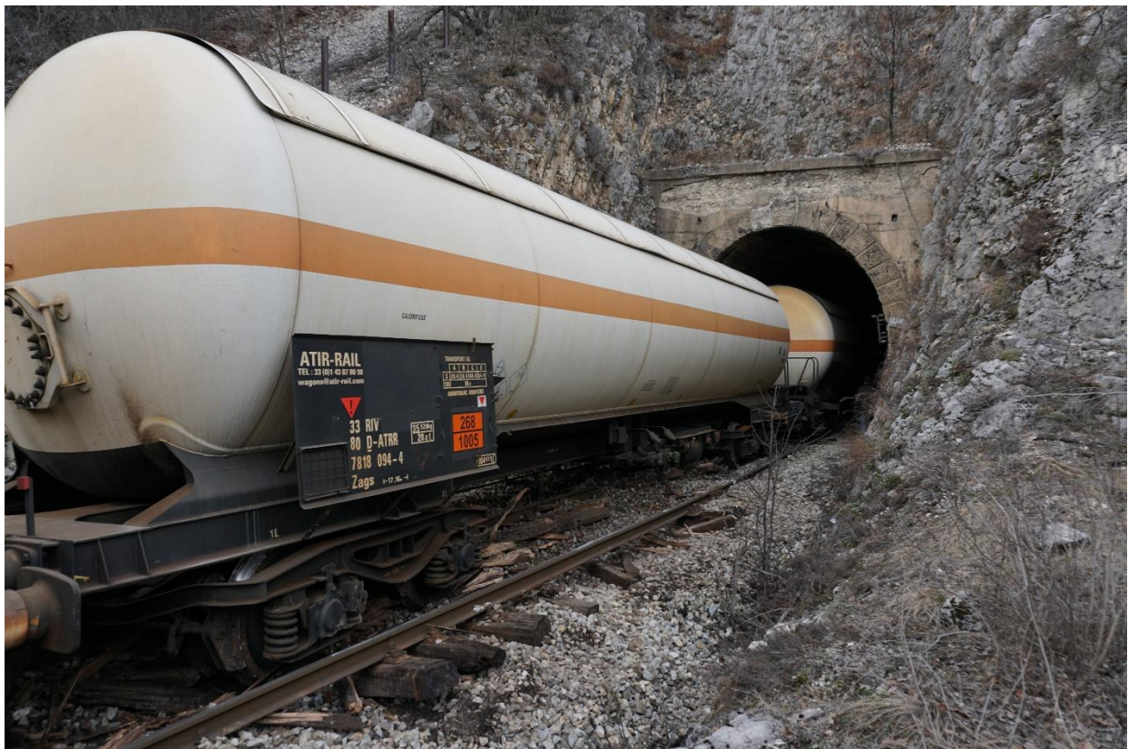
Слика 2.2.2.1: Изглед кола серије Z која су исклизла у несрећи
