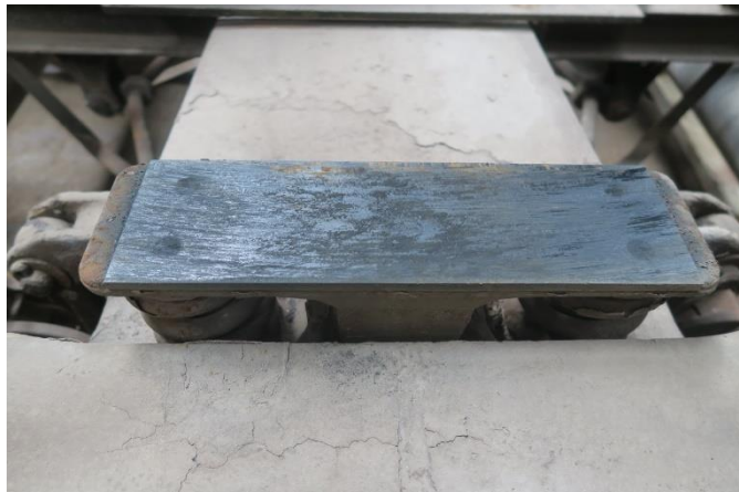
Слика 4.2.6.3: Доњи поклизник кола број 33 87 7814 136-0 код кућишта 7
