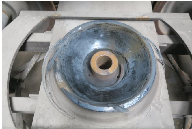
Слика 4.2.6.1: Стање доње обртне шоље кола број 33 87 7814 136-0 код кућишта 7 и 8
