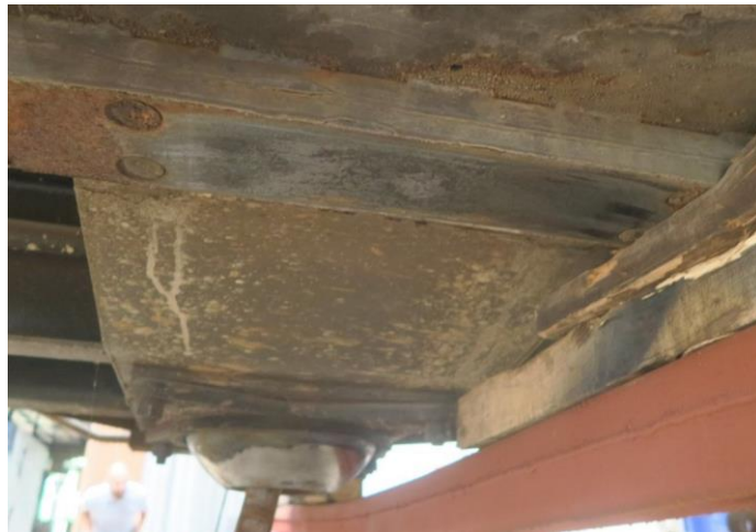
Слика 4.2.6.2: Стање горње обртне шоље и горњег поклизника кола број 33 87 7814 136-0 код кућишта 7 и 8
