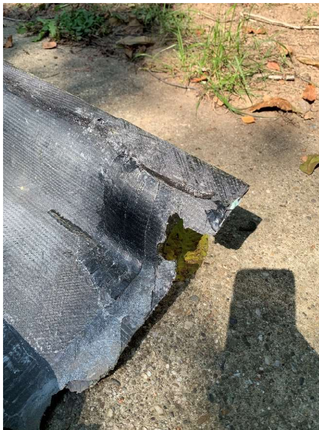
Слика 16. Изглед оштећења када се крилце склони
