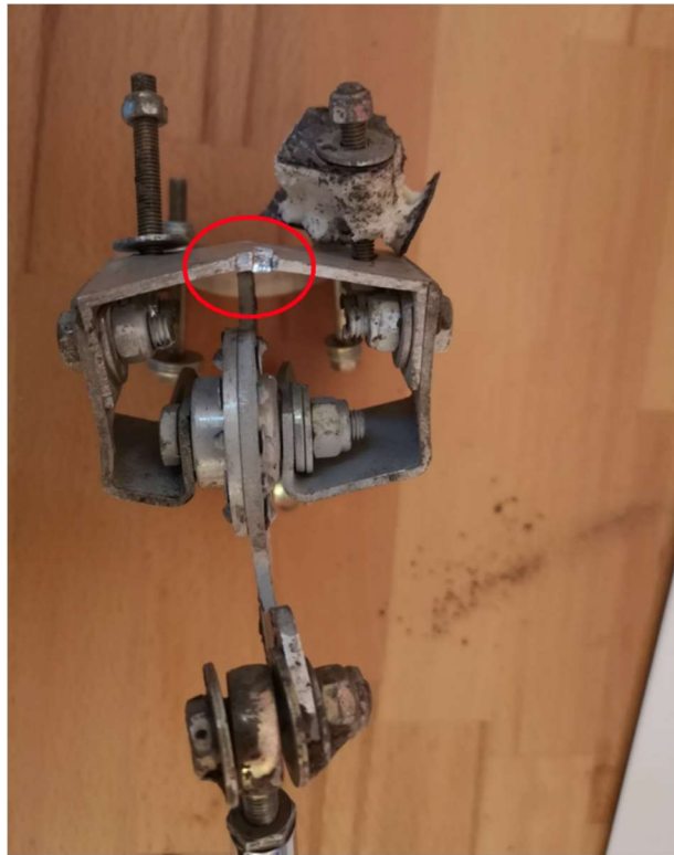
Слика 47: Означено је црвеном елипсом зона удара клацкалице и видљиви урези
