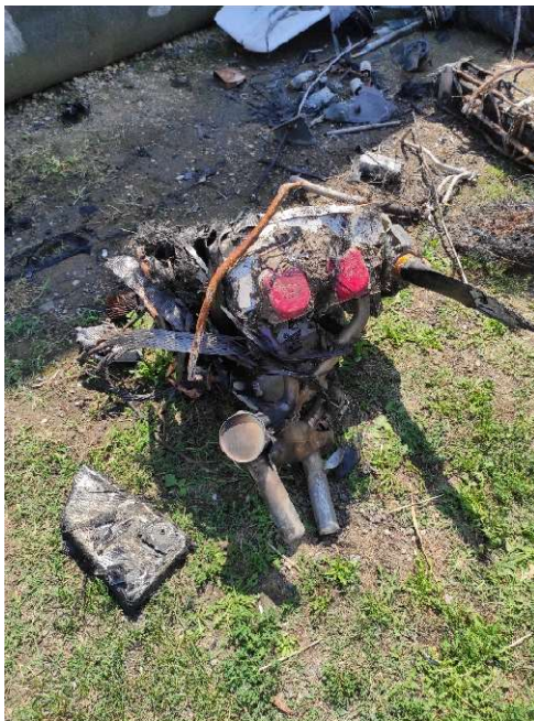
Слика 6 а. Оштећења мотора и елиса
