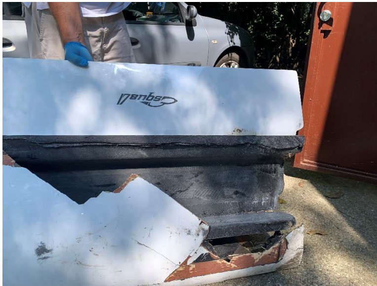
Слика 13. Остаци левог крила са глобалним погледом на лево крилце
