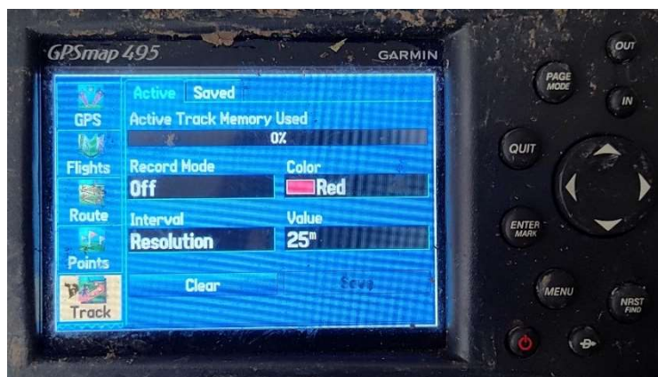
Слика 10. Приказ екрана GPS уређаја, подешавање записа путање ( track )
