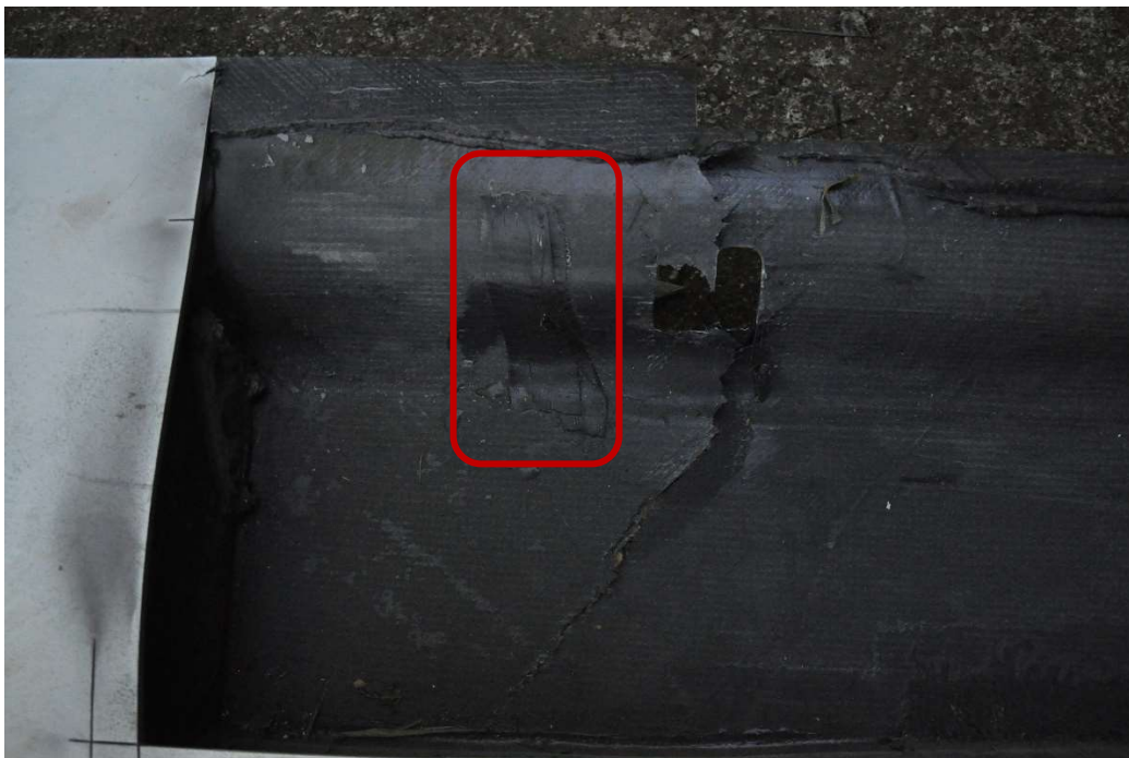
Слика 21. Композитно ојачање на унутрашњем делу доњаке крила, смакнута за неколико центиметара у односу на место споја унутрашњег носача крилца
