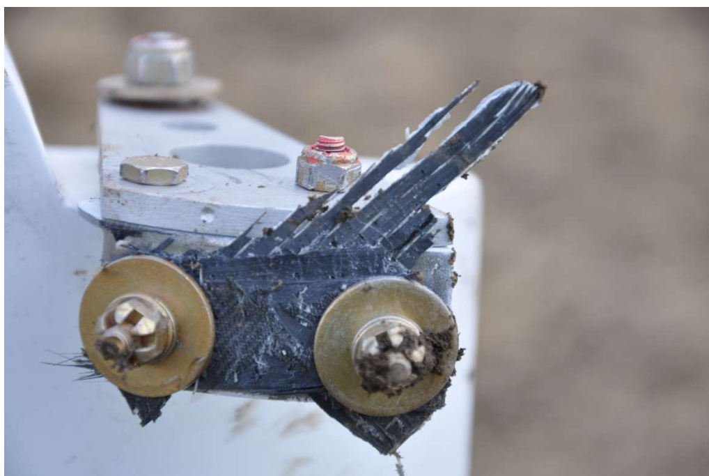
Слика 22. Лево крилце, спољашњи фитинг са остатком композитних платана на месту споја са крилом
