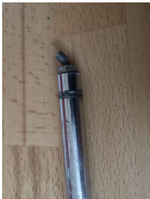
Слика 48. Искривљени врх „rod end-a“, део који се спаја са крилцем
