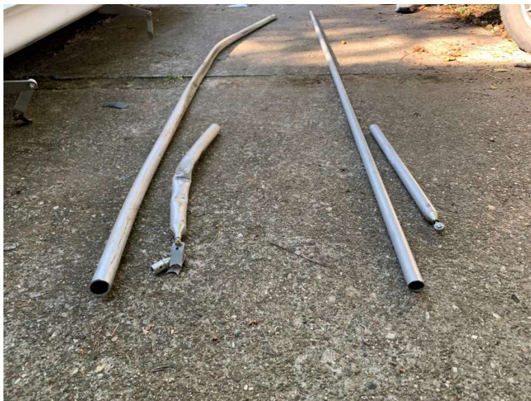
Слика 28. Пресек цеви и упоредни приказ цеви која је замењена и цеви са којом је извршен лет
