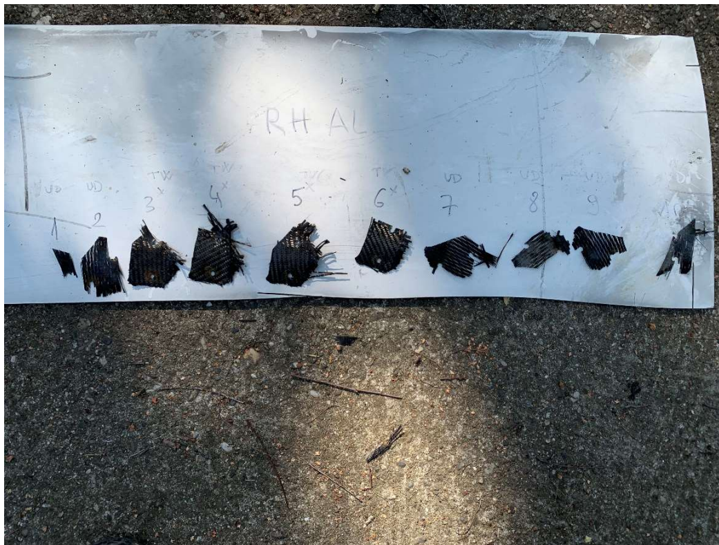
Слика 25. Број ламина (10) на сегменту који је притегнут завртњевима са десног крилца који је остао на авиону и крилу
