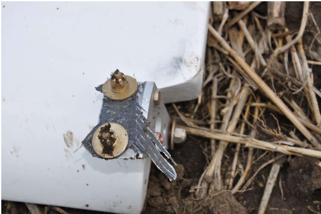
Слика 19. Носач левог крилца прикачен за крилце где су видљиви слојеви композита и завртањска веза
