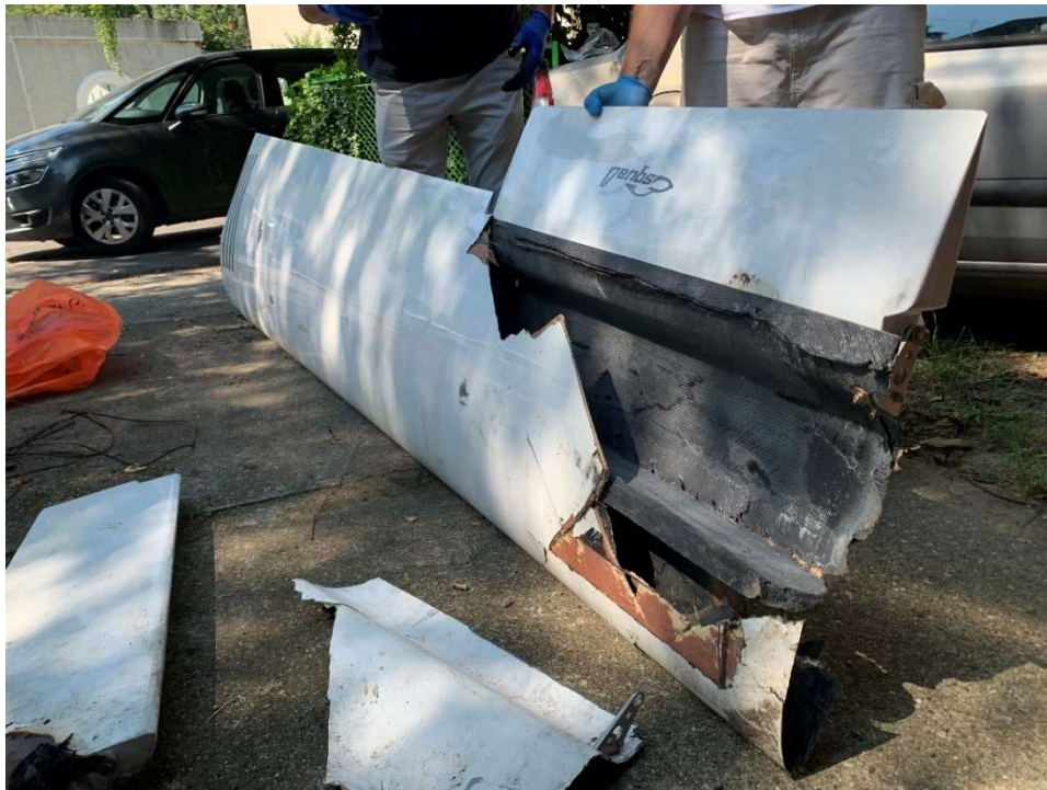
Слика 12. Остаци левог крила са глобалним погледом на лево крилце
