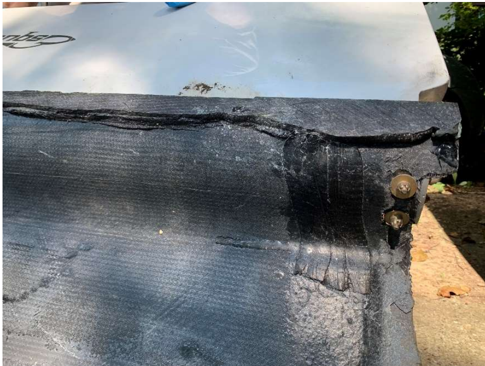
Слика 15. Терминезон левог крила са додатком крилца које је ручно постављено у позицију са погледом на спољни носач крилца
