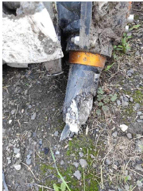
Слика 6 а. Оштећења мотора и елиса
