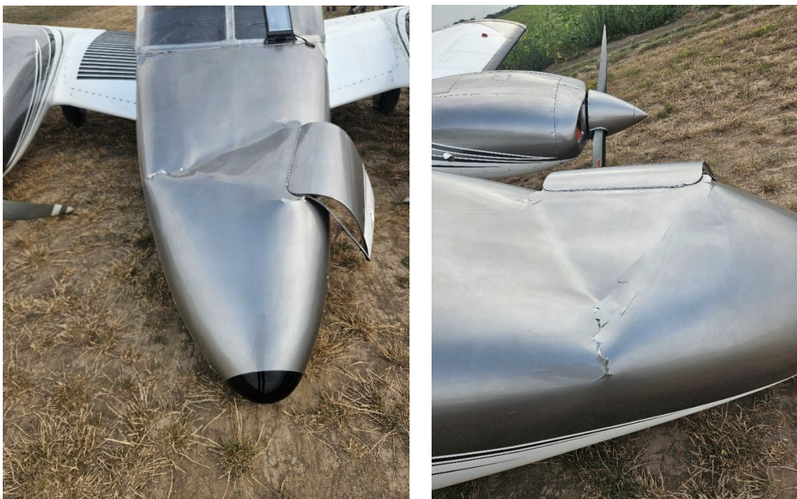
Слика 2. Пластична деформација дела моторног поклопца и феринг ( fairing ) панела (носна секција)
