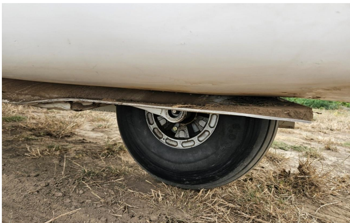
Слика 6. Деформација доње облоге трупа
