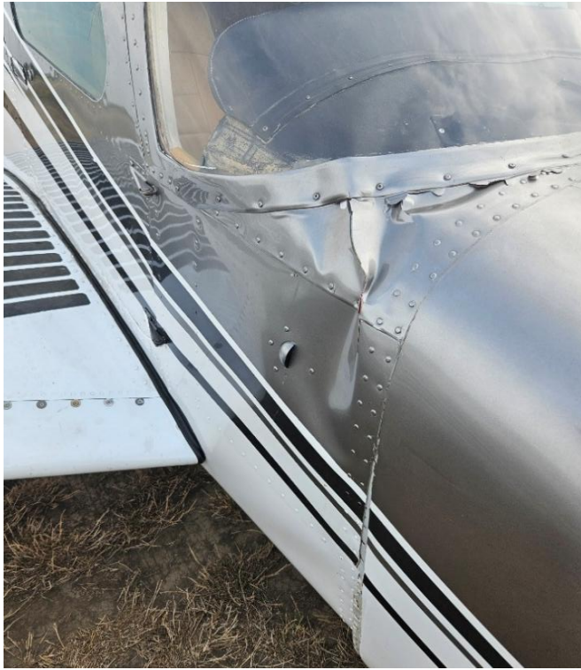
Слика 3. Оштећења бочног дела трупа у зони споја труп–крило
