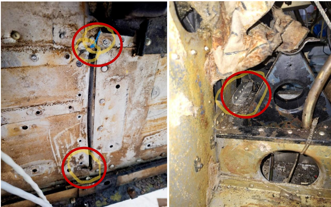
Слика 15. Приказ претходних оправки, даблер и профил
