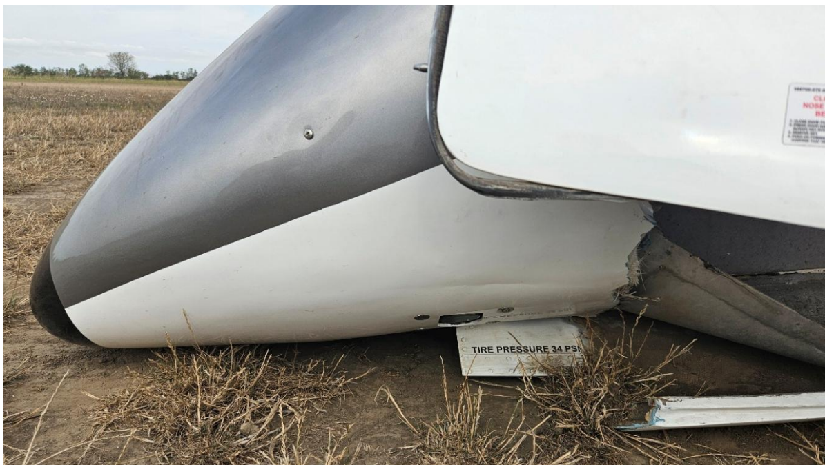
Слика 5. Оштећења доњег панела моторног поклопца
