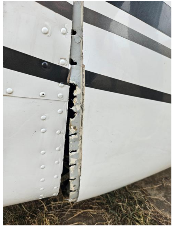
Слика 3. Оштећења бочног дела трупа у зони споја труп–крило
