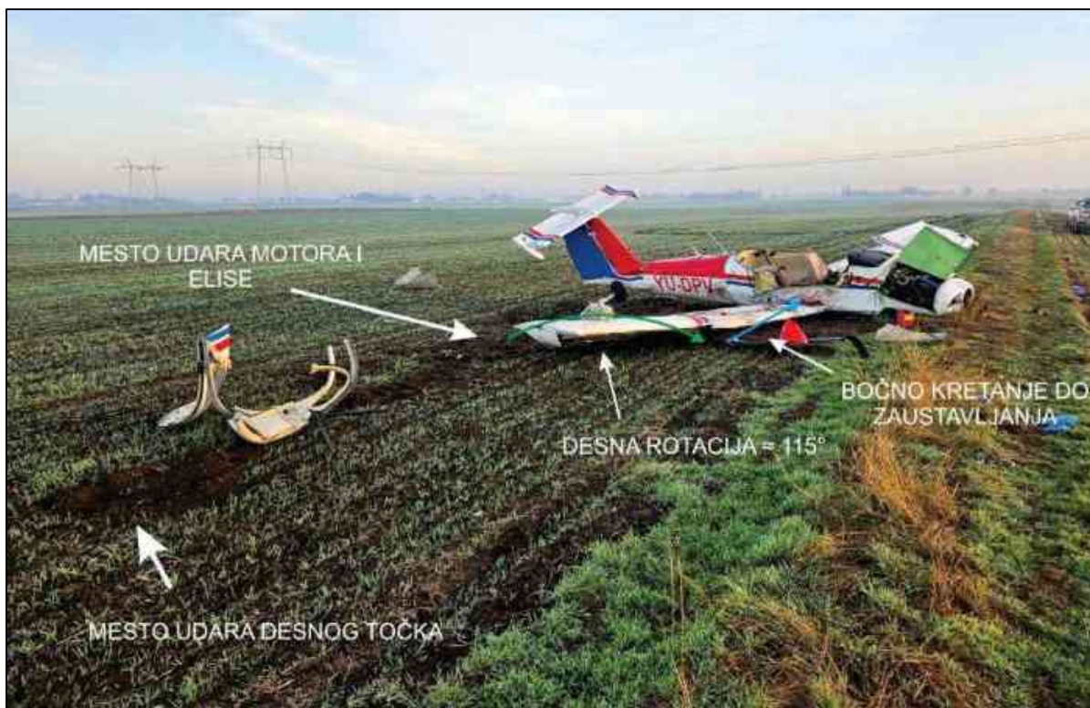
Слика 16.Опис заустављања авиона приликом пада
