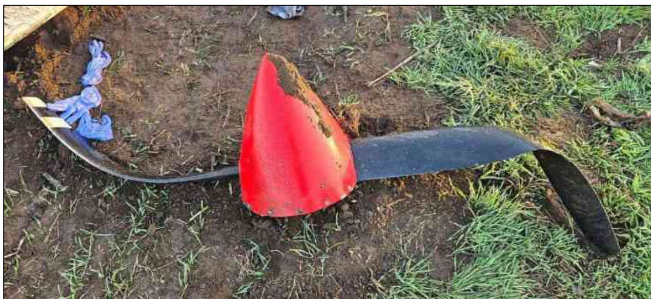
Слика 15. Оштећење пропелера
