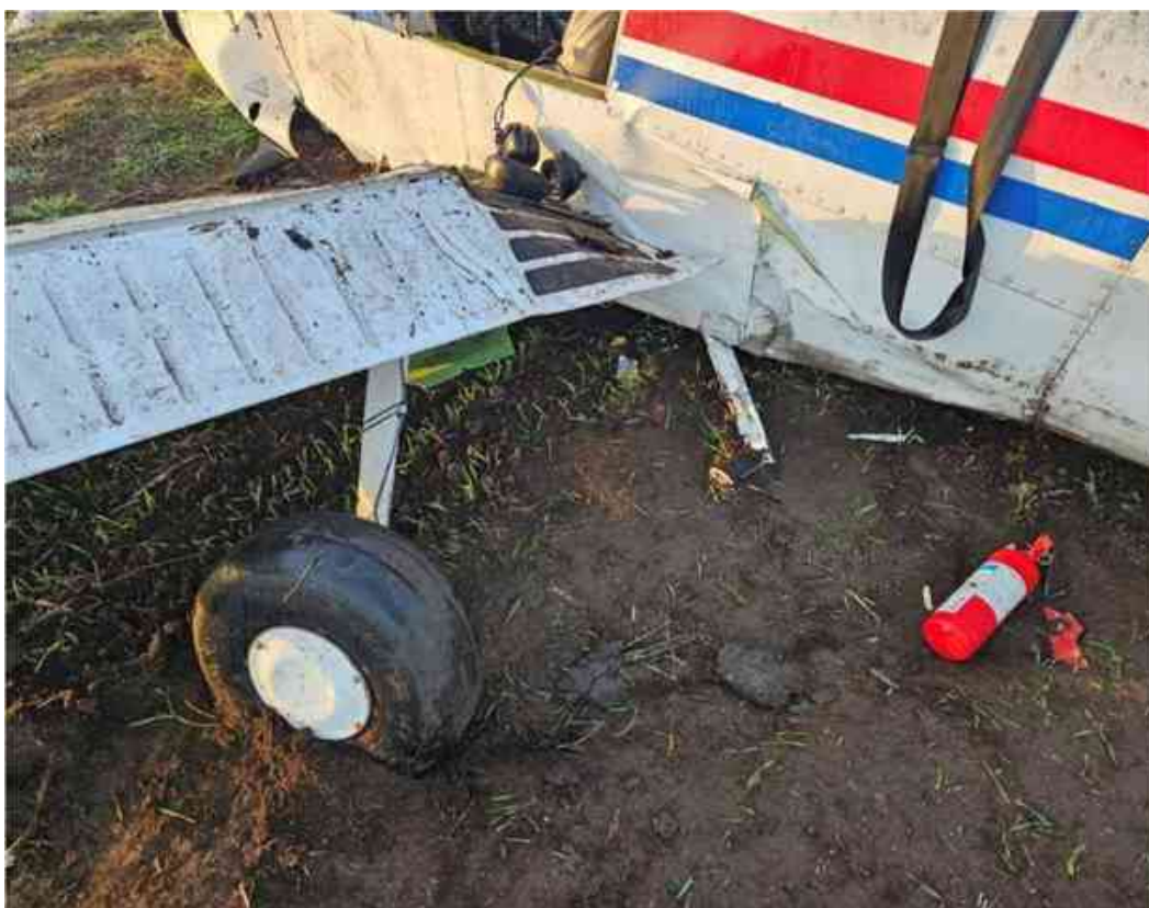
Слика 4. Оштећења репа и крила
