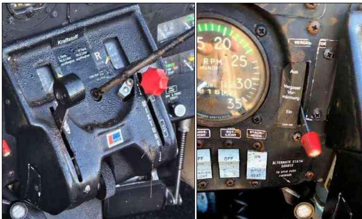
Слика 17. Команда грејања карбуратора и грејање пито цев
