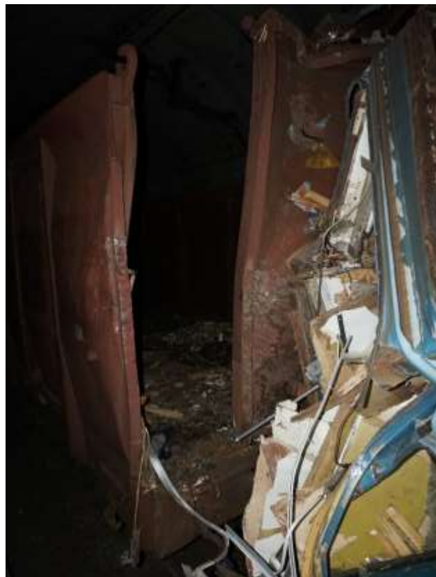
Слика 4.2.1.3: Изглед деформације вагона број 31 72 5959 453-7 код воза број 52601 после несреће
