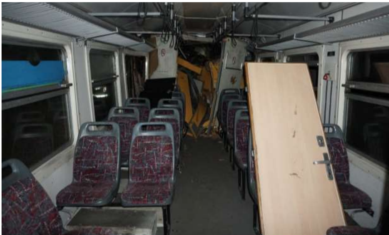
Слика 4.2.1.2: Изглед деформација у простору за путнике моторних кола 412-005 код воза број 7112 после несреће
