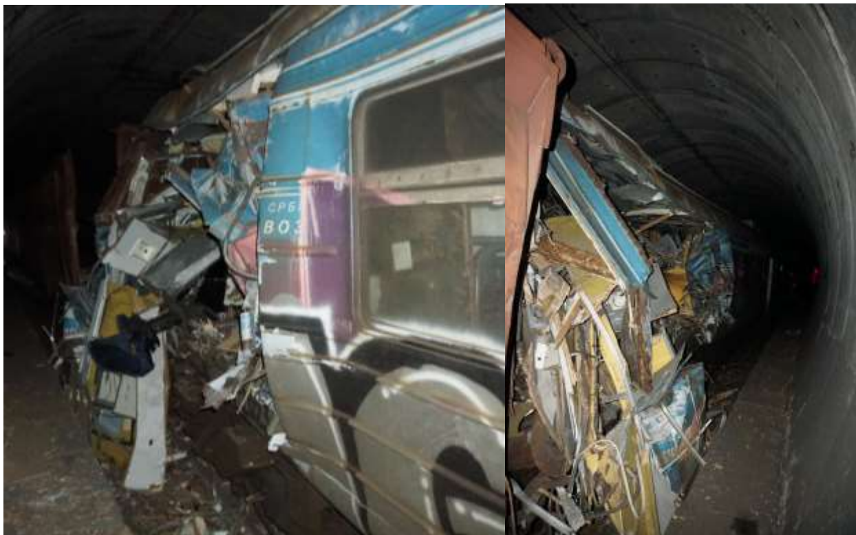
Слика 4.2.1.1: Изглед оштећења на предњем делу моторних кола 412-005 код воза број 7112 после несреће
