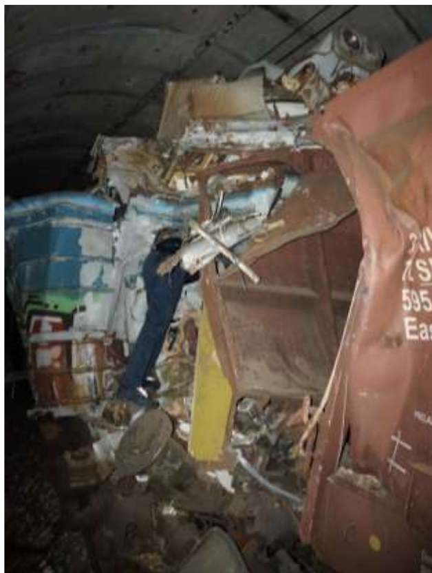
Слика 4.2.1.3: Изглед деформације вагона број 31 72 5959 453-7 код воза број 52601 после несреће
